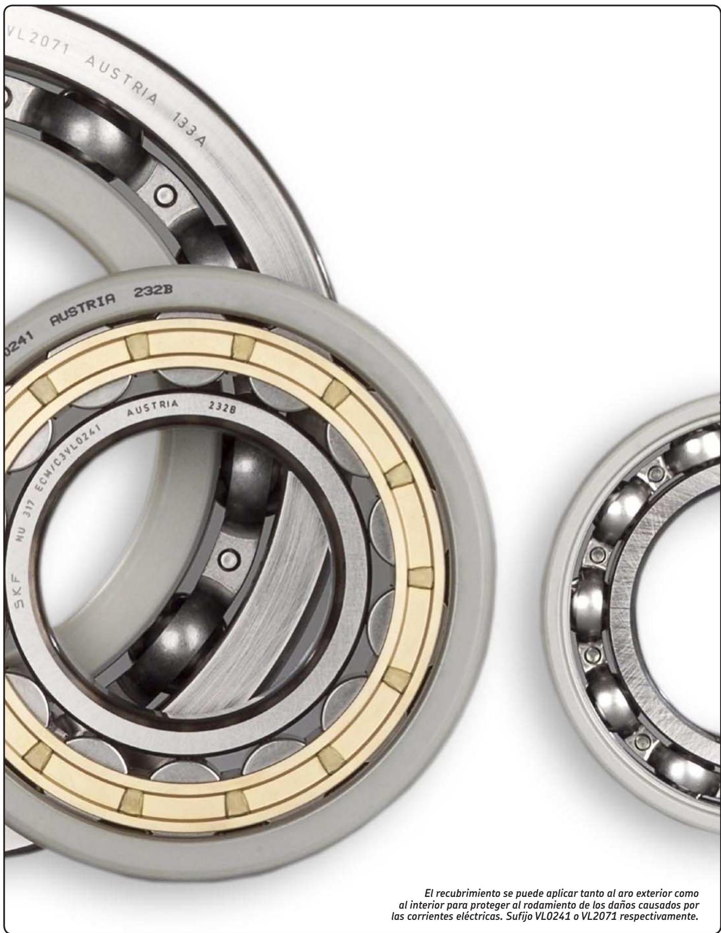
*El recubrimiento se puede aplicar tanto al aro exterior como al interior para proteger al rodamiento de los daños causados por las corrientes eléctricas. Sufijo VL0241 o VL2071 respectivamente.*
