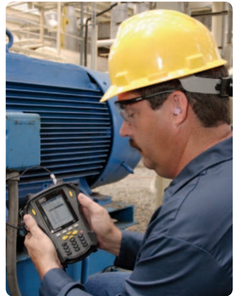
Enregistrement de valeurs de vibrations à l'aide du Collecteur de données Microlog de SKF
