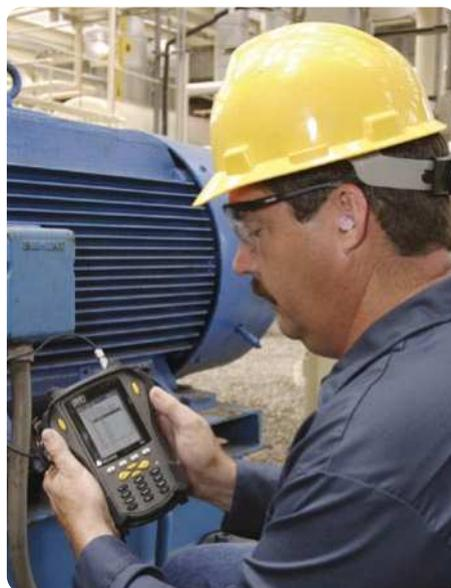
*Enregistrements des vibrations à l'aide d'un collecteur de données de série SKF Microlog*
