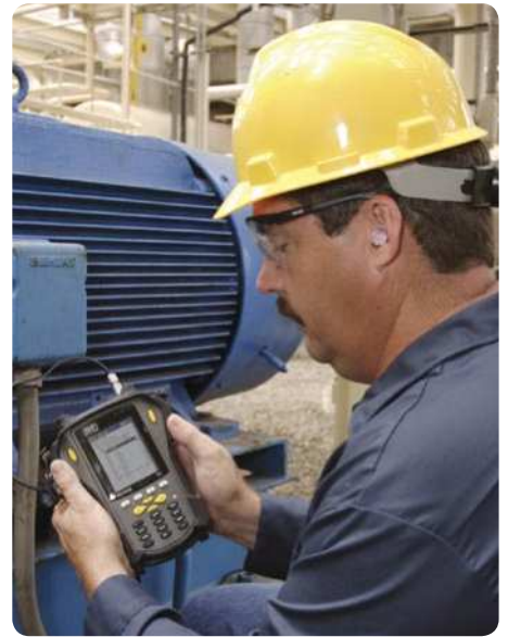
Registro de los valores de vibración usando un colector de datos de la serie SKF Microlog
