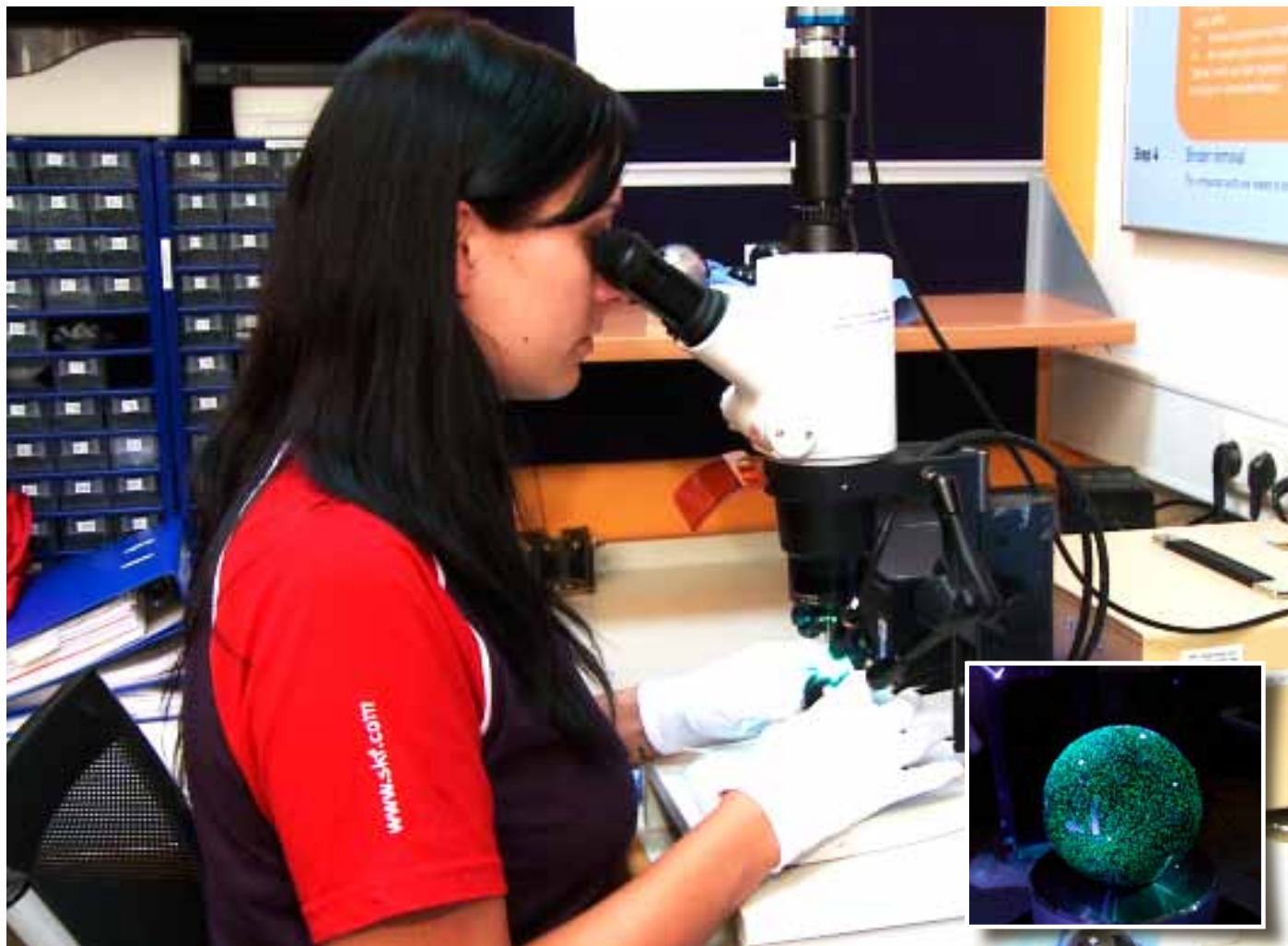
Fig. 1: Inspección de bolas cerámicas de 47,625 mm de diámetro (derecha) usadas en rodamientos para aerogeneradores.
