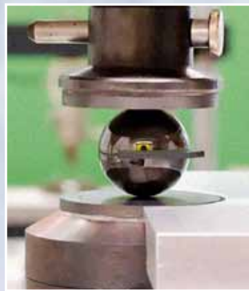
Fig. 5: Principio de bola con muescas para evaluación de la resistencia a la flexión de las bolas de cerámica.
