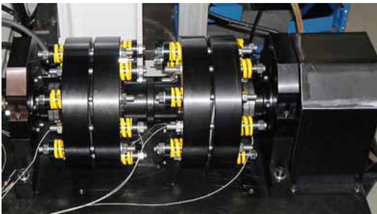
Fig. 9: Banco de pruebas de resistencia durante la vida de servicio con cuatro rodamientos híbridos 7318 sometidos a carga axial.
