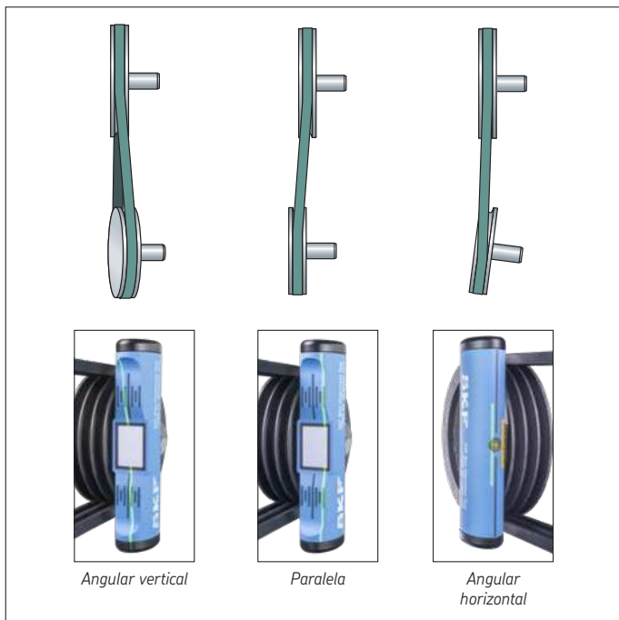
Imagen 5 Tipos de desalineación
