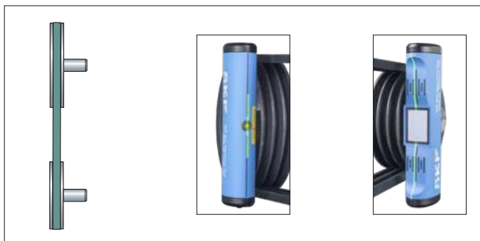
Рисунок 9 Соосность шкивов после правильно выполненной выверки
