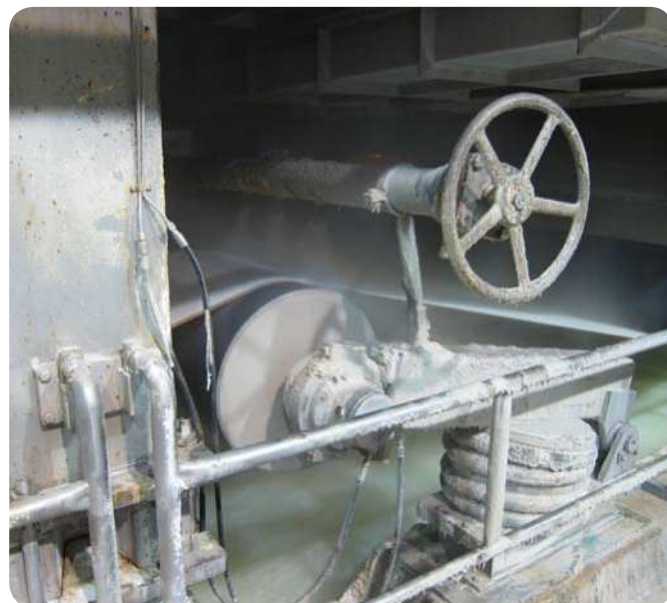
Fig. 7 Entorno de alta humedad de un rodillo tensor de la sección de conformación de una máquina papelera. La grasa en el sello laberíntico detiene el ingreso del agua del proceso al soporte del rodamiento.
