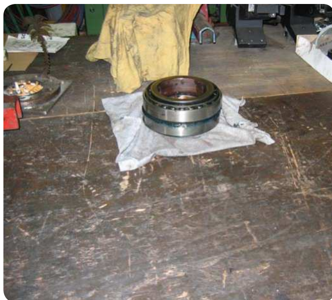
Fig. 2 Es difícil limpiar bien los bancos de trabajo de madera.
