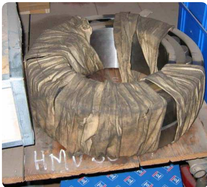
Fig. 5 Rodamiento guardado sin protección contra el polvo.
