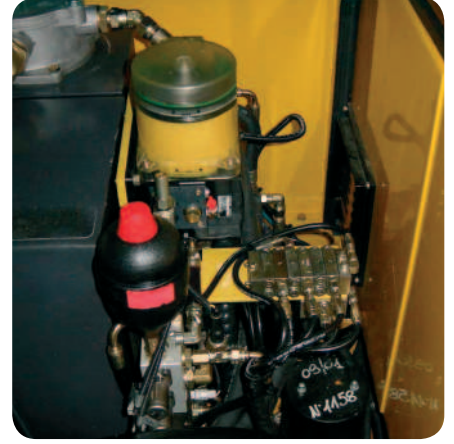
KOMATSU PW95 üzerinde entegre elektronik kontrollü pompa ünitesi.
