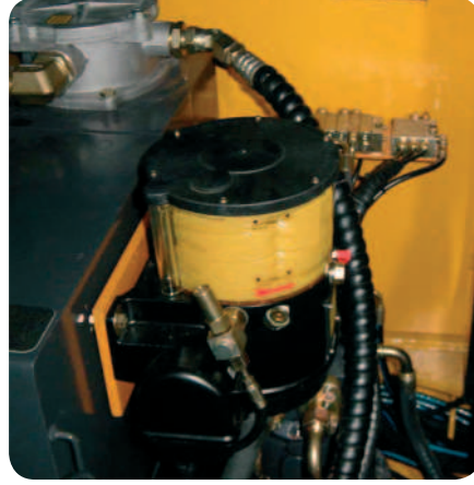
KOMATSU PC110 üzerinde entegre elektronik kontrollü pompa ünitesi.
