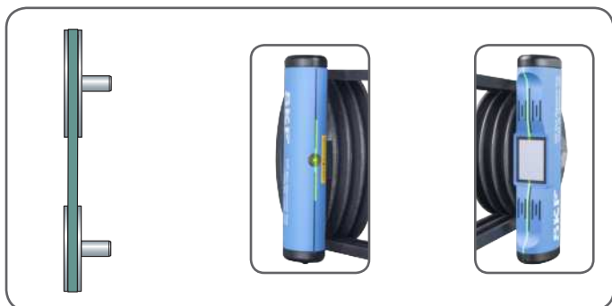
9. ábra Tökéletesen beállított ékszíjtárcsák
