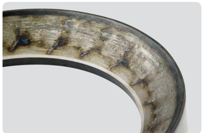
**Außenring eines Axial-Pendelrollenlagers**
