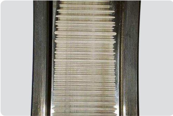
**Außenring eines Zylinderrollenlagers**
