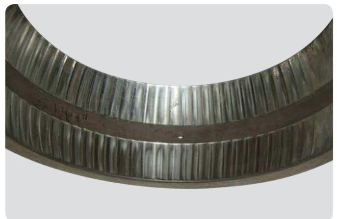
**Außenring eines Pendelrollenlagers**
