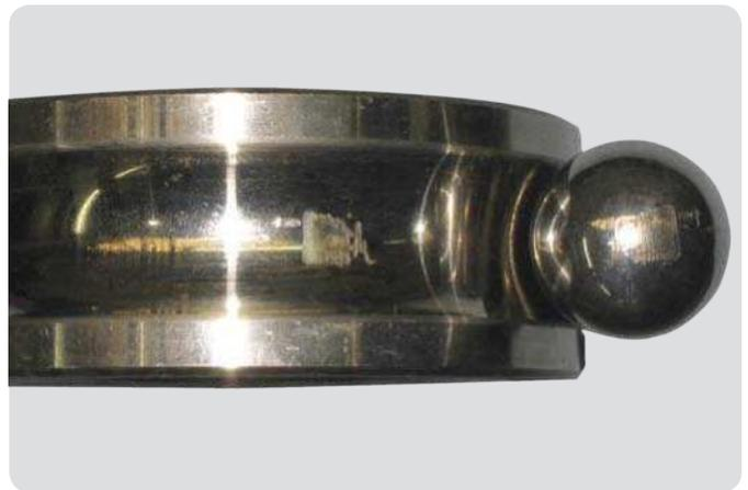
**Innenring und Kugel eines Rillenkugellagers**
