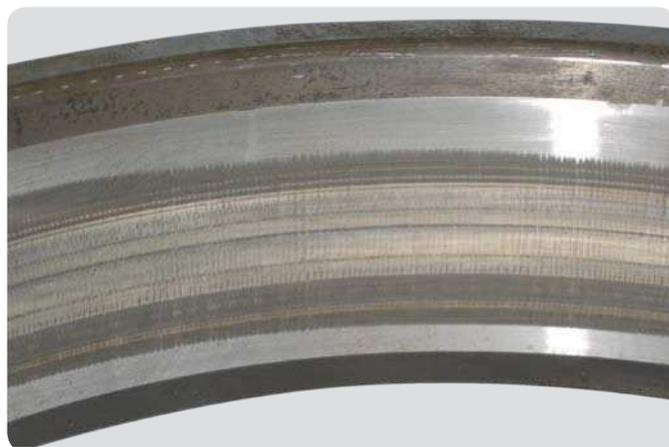
**Außenring eines Zylinderrollenlagers**
