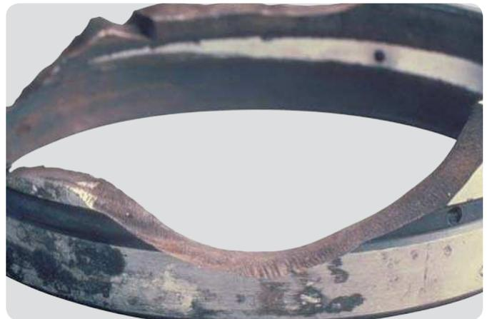
**Außenring eines Pendelrollenlagers**
