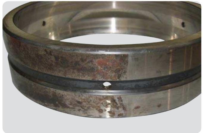
**Außenring eines Pendelrollenlagers**
