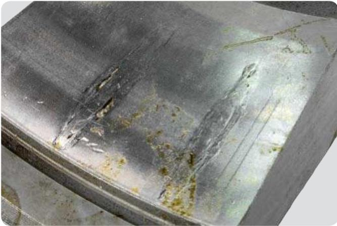
**Außenring an einem zweireihigen Kegelrollenlager**
