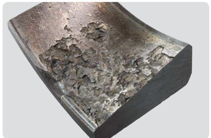
**Außenring eines Kegelrollenlagers**
