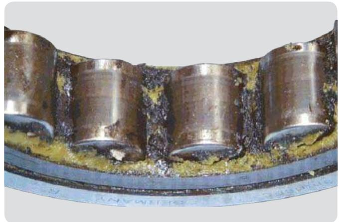
**Außenring eines Zylinderrollenlagers mit Käfig, Rollen und Schmierfett**
