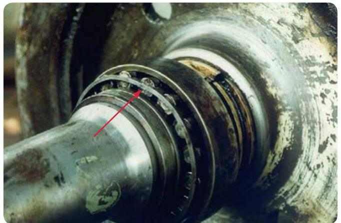
**Auf Eisenbahnradsatz montiertes Kegelrollenlager**
