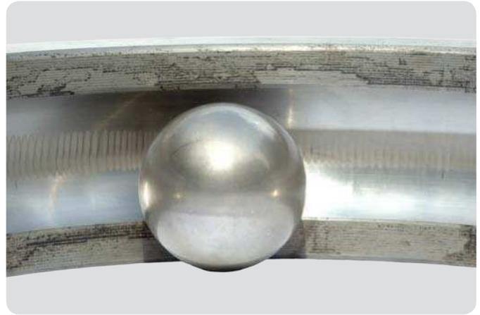
**Außenring und Kugel eines Rillenkugellagers**
