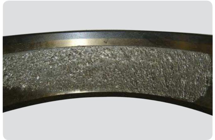
**Außenring eines Zylinderrollenlagers**
