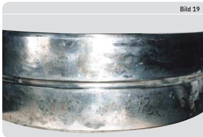
*Außenring: starker Passungsrost in der Lastzone des Außendurchmessers*
