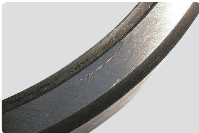
**Stirnseite des Außenrings eines Rillenkugellagers**
