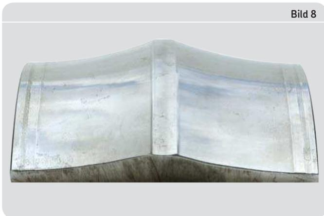
**Außenring: starker abrasiver Verschleiß an den Laufbahnen und querlaufende Anschmiermarken**
