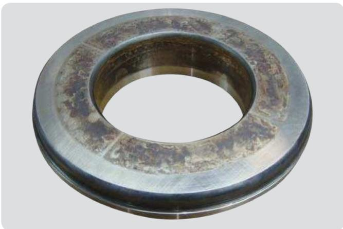
**Wellenscheibe eines Axial-Pendelrollenlagers**
