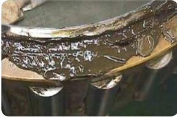
**Verringerung der Schmierstoffviskosität durch flüssige Verunreinigungen**
