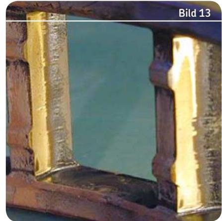
*Reibverschleiß an den Käfigstegen eines Zylinderrollenlagers*
