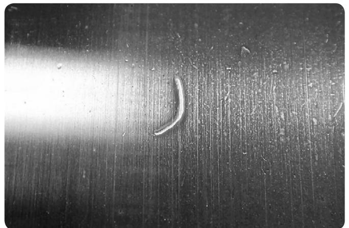
**Außenring eines Pendelrollenlagers**
