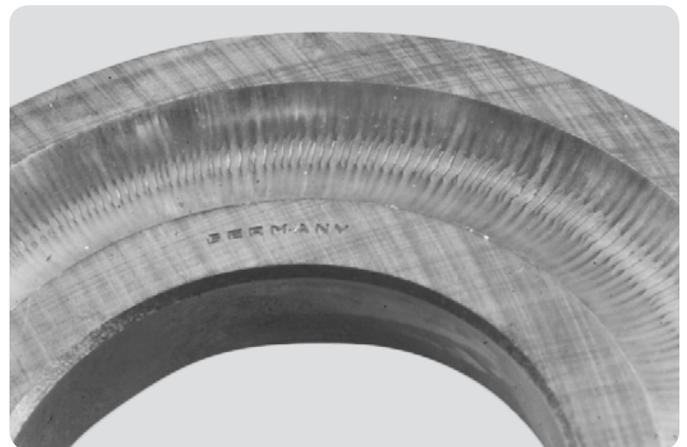
**Wellenscheibe eines Axialkugellagers**
