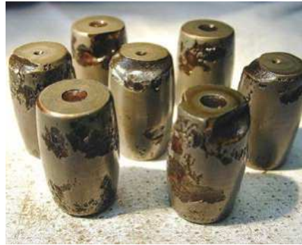
Wälzkörper eines gefälschten Pendelrollenlagers
