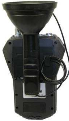
Figura 11 - 8. El micrófono / antena parabólica conectados al Microlog
