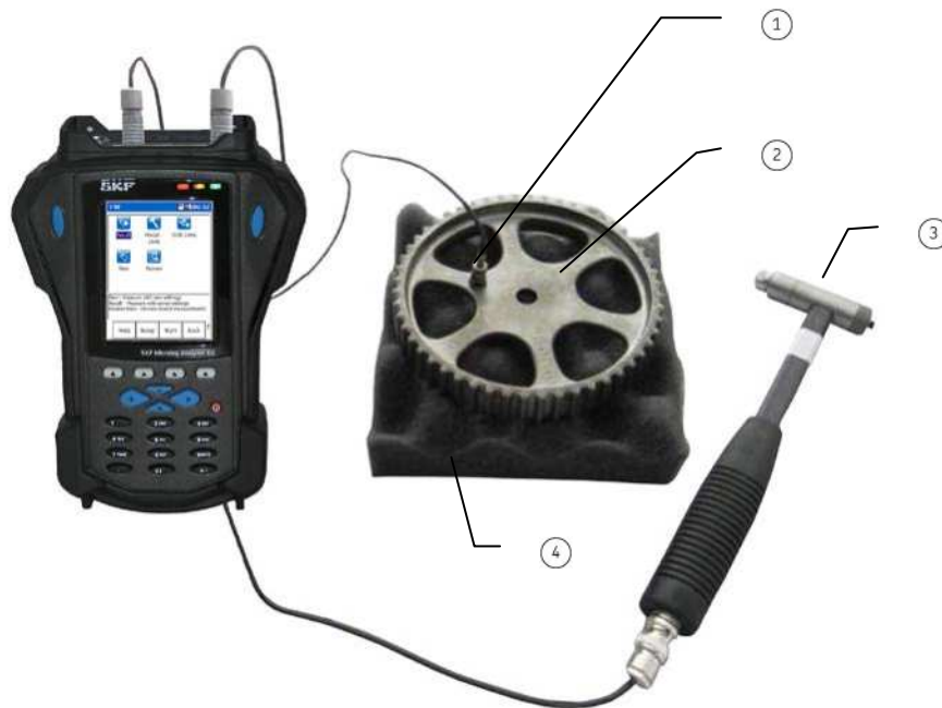
Figura 8 - 1. Ejemplo de configuración de medición de FRF.
