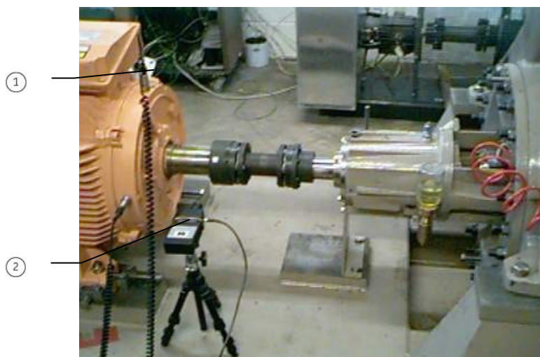
Figura 7 - 1. Configuración habitual de la medición RUCD.
