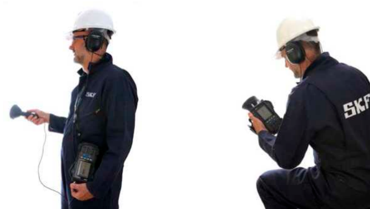
Figura 11 - 6. Dos métodos para sujetar el instrumento: la sujeción del hombro y la sujeción manual.
