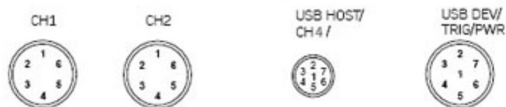
Figura 1 - 12. Detalle del conector del sistema Microlog.
