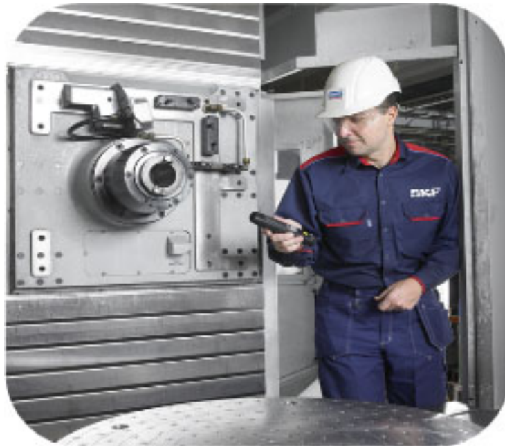
Figura 10 - 30. Controle la velocidad con el tacómetro.
