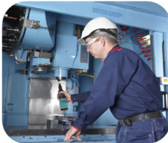
Figura 10 - 18. Realizar una prueba de fuerza de abrazadera.
