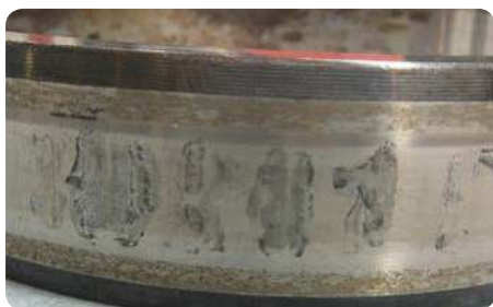
Corrosión por humedad en el aro interior de un rodamiento de rodillos cilíndricos
