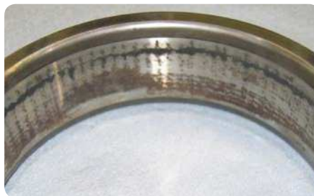
Corrosión de contacto en el agujero de los rodamientos producida por un ajuste inadecuado en el eje
