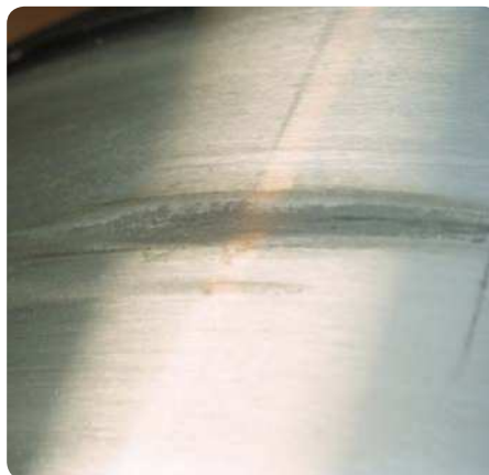
Desgaste adhesivo en el camino de rodadura del aro interior de un rodamiento de rodillos cilíndricos
