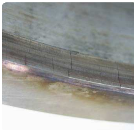
Agrietamiento térmico Agrietamiento térmico del reborde del aro exterior de un rodamiento de rodillos cilíndricos
