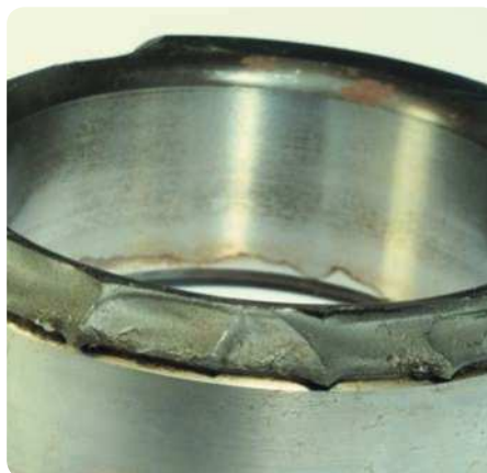
Fractura forzada Bridas agrietadas del aro interior de un rodamiento de rodillos cilíndricos a causa de una carga de impacto
