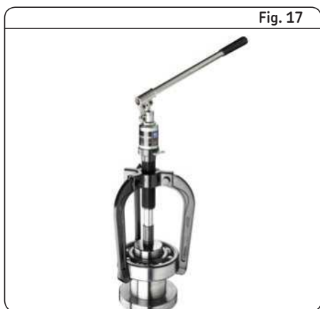
Minimice los daños girando el aro exterior
