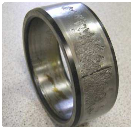
Fractura por fatiga Fractura por fatiga del aro interior de un rodamiento de rodillos cilíndricos
