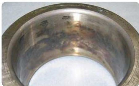
Corrosión de contacto en el agujero de los rodamientos producida por un ajuste inadecuado en el eje
