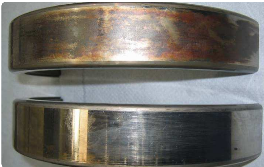
Corrosión de contacto en el diámetro exterior de un rodamiento
