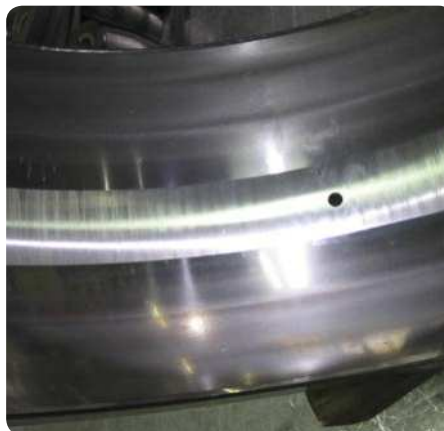
Caminos de rodadura del aro exterior de un rodamiento de rodillos a rótula con desgaste abrasivo
