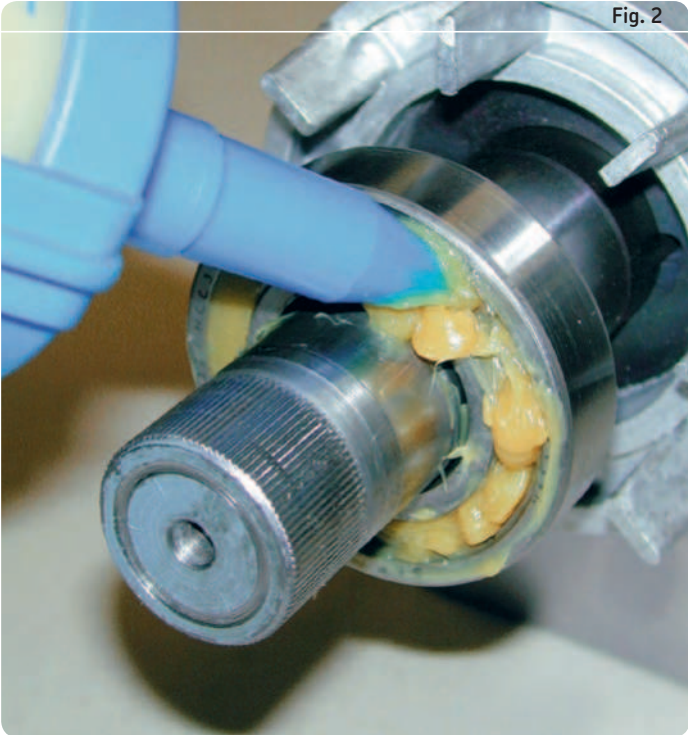
Engrase de un rodamiento rígido de bolas montado en un eje de rotor
