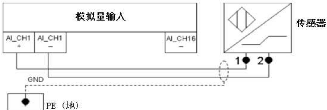
图 3 - 6. 灵活负载传感器导线细节。
