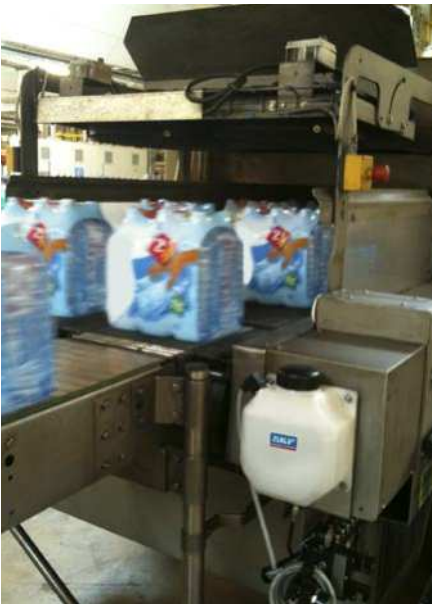
Für die Kettenschmierung in Verpackungsmaschinen, Palettiermaschinen, Schrumpffolien-Verpackungsmaschinen usw. verwendbar.
