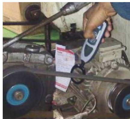
4 Zur Lokalisierung elektrischer Entladungen das SKF Messgerät zum Erkennen von Funkenerosion TKED 1
