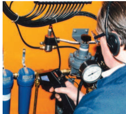
2 Zum Erkennen von Luft-Leckagen das SKF Ultraschallmessgerät CMIN 400
