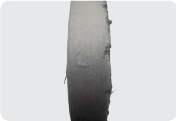
Повреждена одна из кромок ремня.
