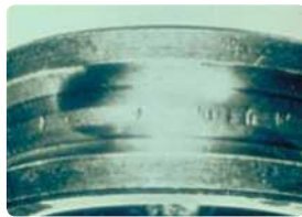
Vaihe 3: Vierintäelimet kulkevat partikkelien yli; varsinainen pinnan kuoriutuma alkaa.
