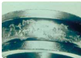
Vaihe 4: Jos laakeria käytetään liian pitkään, kuoriutuma tapahtuu koko vierintäpinnan matkalta; alkuperäistä vauriota ei ole enää näkyvissä.
