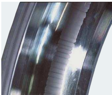
滚道上的凹槽通常是由于破坏性电流通过轴承而导致的二次损坏。
