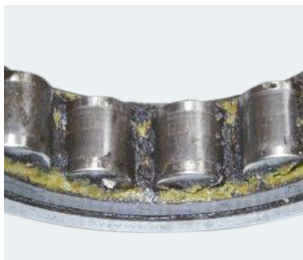
带保持架、滚子和润滑脂的圆柱滚子轴承外圈: 电流泄漏导致保持架梁上的润滑脂烧焦(变黑)
