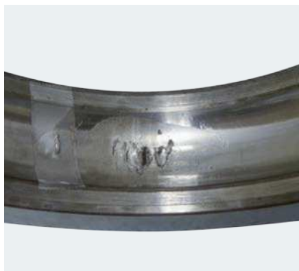
球轴承滚道由于大电流腐蚀出现较大剥落
