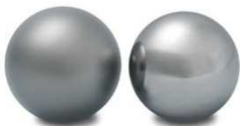
高频电流泄漏腐蚀导致的微型凹坑。带(左)和不带(右)微型凹坑的滚珠的比较
