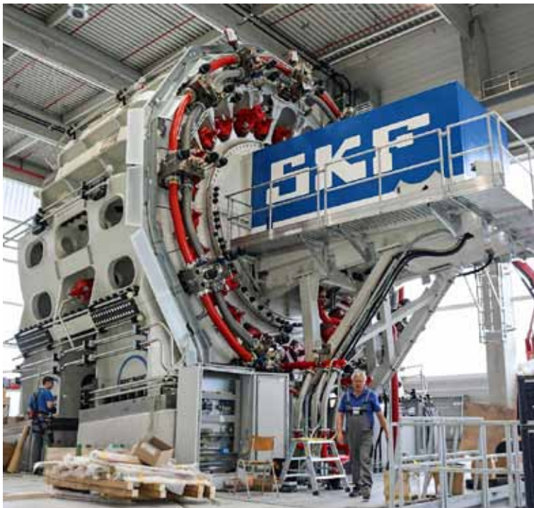
Bild 4: Montage des größten Prüfstandes kurz vor der Fertigstellung.
