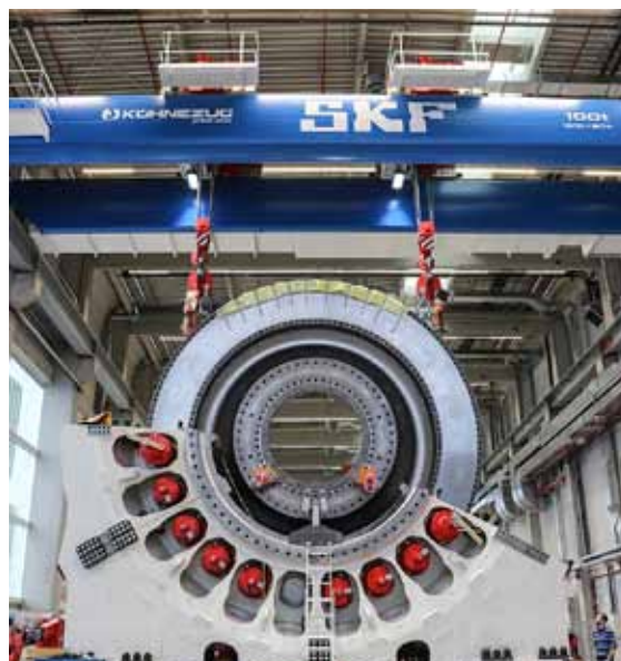
Bild 3: Montage des größten Prüfstandes. Die 125 Tonnen schwere Scheibe wird in der unteren Hälfte des Prüfstandes angebracht.
