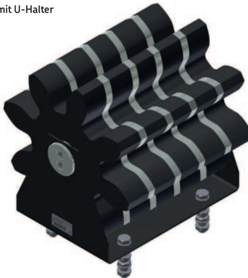
Die Baureihe LPC ist die kundenspezifische SKF Lösung für jeden Bedarf innerhalb des metrischen Systems, der nicht vom Standardprogramm abgedeckt wird. Diese Schmierritzel bestehen aus Metallzahnradern mit Schaumgummibeschichtung. Die Schaumgummibeschichtung garantiert eine gleichmäßige Verteilung des Schmierstoffs über die gesamte Zahnbreite. Die Metallzahnräder sind verschleißfest und beständig gegenüber allen Schmierstoffen und Umwelteinflüssen.
