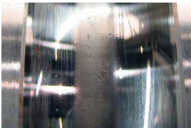
Aro interior de un rodamiento rígido de bolas Muecas resultantes del desplazamiento excesivo de partículas duras; disposición de sellado inadecuada
