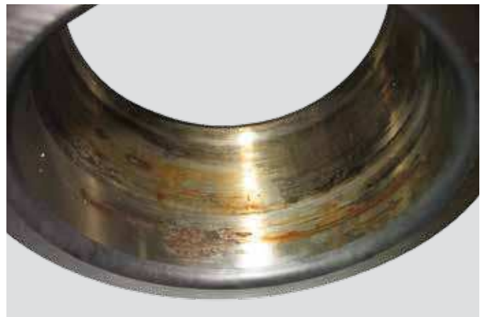
Aro interior de rodamiento de rodillos cónicos Ajuste de eje inadecuado
