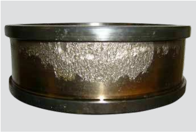
Aro interior de rodamiento de rodillos cilíndricos Película de lubricante inadecuada, desalineación excesiva, deformación superficial avanzada
