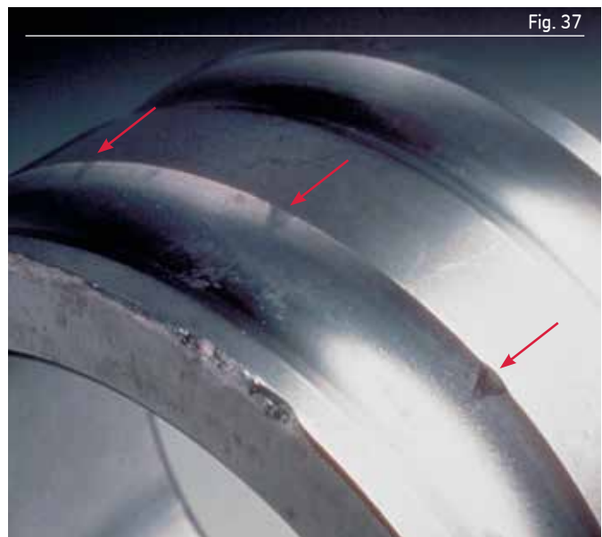
Indentaciones en el paso de la bola en el camino de rodadura de un rodamiento de dos hileras de bolas de contacto angular resultante del montaje incorrecto
