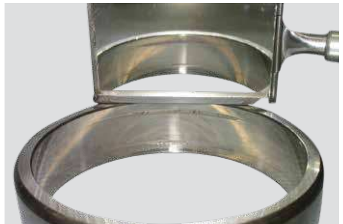
Aro exterior de rodamiento de bolas a rótula Descascarillado a 180°, resultante de carga excesiva debido a fijación ovalizada
