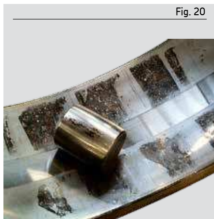
Corrosión sobre el aro exterior y el rodillo de un rodamiento de rodillos a rótula
