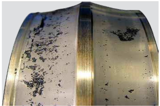
Aro interior de rodamiento de rodillos a rótula Película de lubricante inadecuada. El desgaste abrasivo inicial debido a contaminación se transformó en deformación superficial y descascarillado
