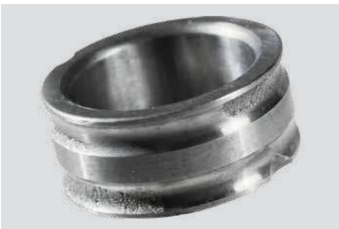
Aro interior de rodamiento de dos hileras de bolas de contacto angular Desalineación excesiva, que resulta en cargas excesivas con dos zonas de carga a 180°
