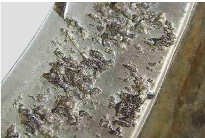
Aro exterior de rodamiento de rodillos a rótula El desgaste abrasivo inicial debido a contaminación se transformó en deformación superficial y descascarillado avanzado
