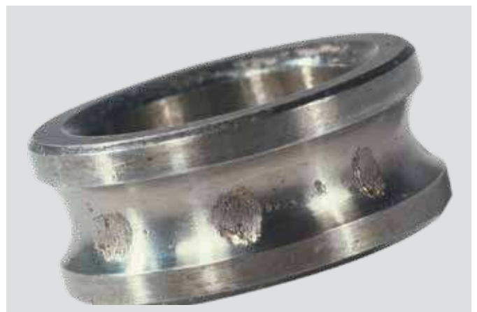
Aro interior de rodamiento rígido de bolas Impacto durante el montaje, que ocasiona descascarillado en el paso de las bolas
