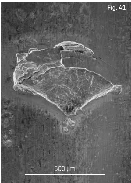
Descascarillado en el aro interior de un rodamiento rígido de bolas, resultante de una indentación
