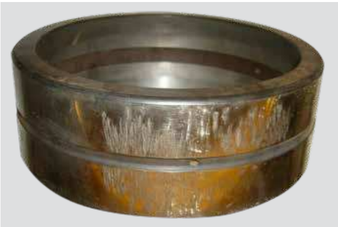
Aro exterior de rodamiento de rodillos a rótula Área de corrosión por contacto de color marrón, causada por micromovimientos debido a descascarillado avanzado en camino de rodadura, con rayaduras por el desmontaje
