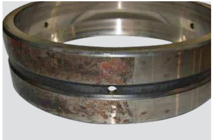
Aro exterior de rodamiento de rodillos a rótula Aro con apoyo inadecuado
