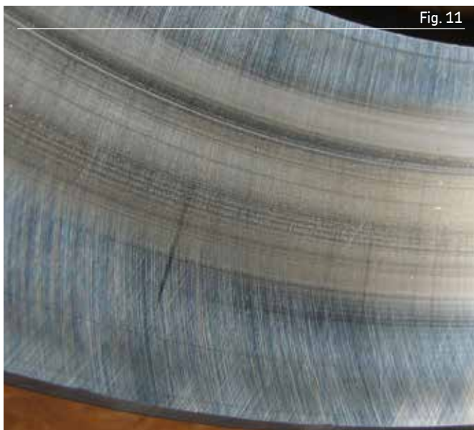
Desgaste abrasivo ligero en el aro exterior de un rodamiento axial de rodillos a rótula
