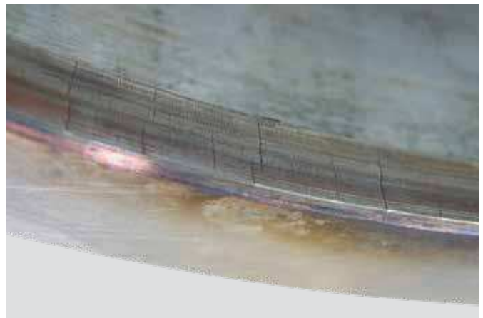
Aro exterior de rodamiento de rodillos cilíndricos Grietas térmicas en el contacto resalte-jaula debido a la lubricación inadecuada
