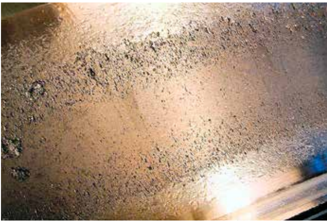
Aro interior de rodamiento de rodillos a rótula Lubricación inadecuada, deformación superficial con descascarillado incipiente
