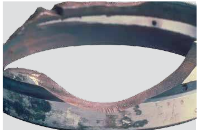
Aro exterior de rodamiento de rodillos a rótula Asiento de soporte inadecuado que causa corrosión por contacto y, finalmente, fractura por fatiga
