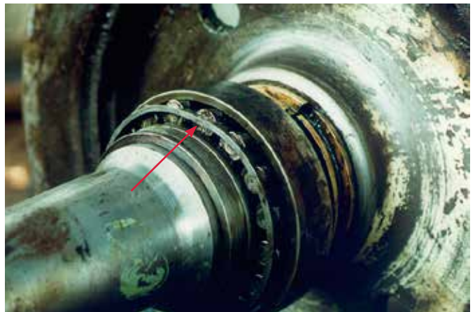
Rodamiento de rodillos cónicos montado en un juego de ruedas ferroviarias En el montaje, la jaula se golpeó en forma directa, lo que causó deformación permanente (aplanamiento)
