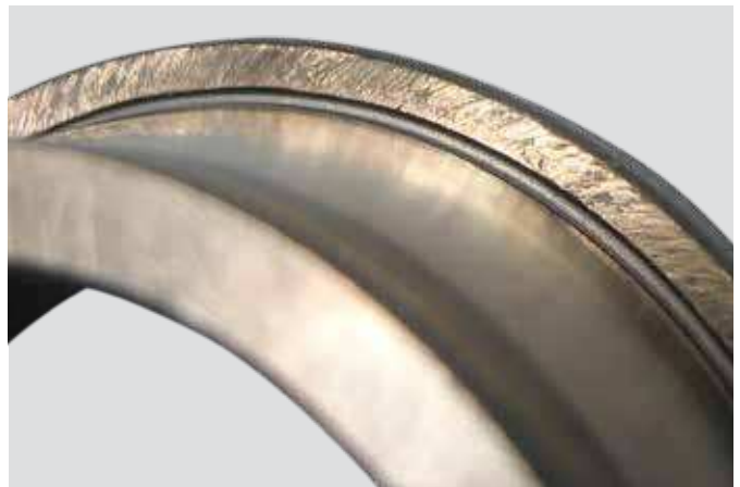
Aro interior de rodamiento de rodillos cónicos Contaminación y lubricación inadecuada que resulta en desgaste por adherencias de la pestaña, y a una pista de rodadura brillante
