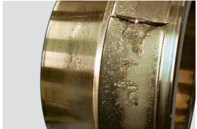
Aro interior de rodamiento de rodillos a rótula Descascarillado muy intenso; fractura por fatiga como daño posterior
