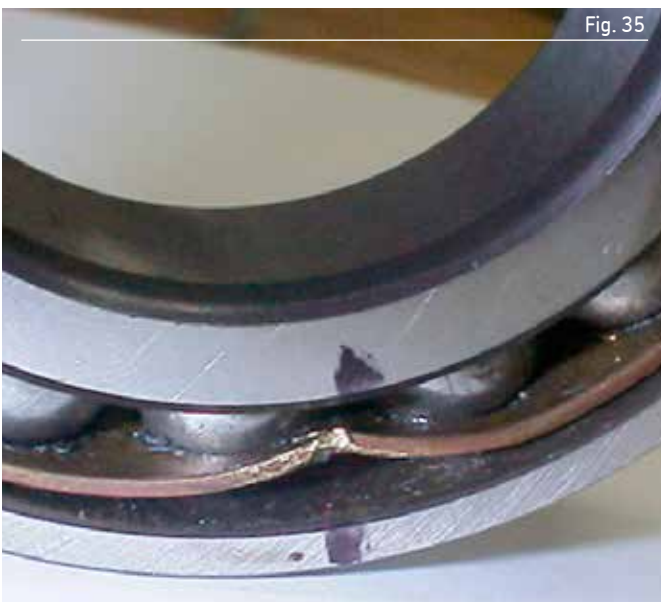
Deformación plástica en la jaula de un rodamiento de bolas de contacto angular resultante del manipuleo inadecuado
