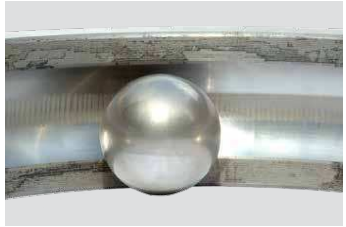
Aro exterior y bola del rodamiento rígido de bolas Ondulación en el aro exterior y superficie de bola opaca
