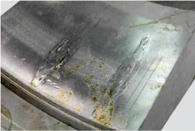
Aro exterior de rodamiento de dos hileras de rodillos cónicos Impacto por sobrecarga y desalineación durante la parada, que origina deformación y el posterior descascarillado en el paso del rodillo
