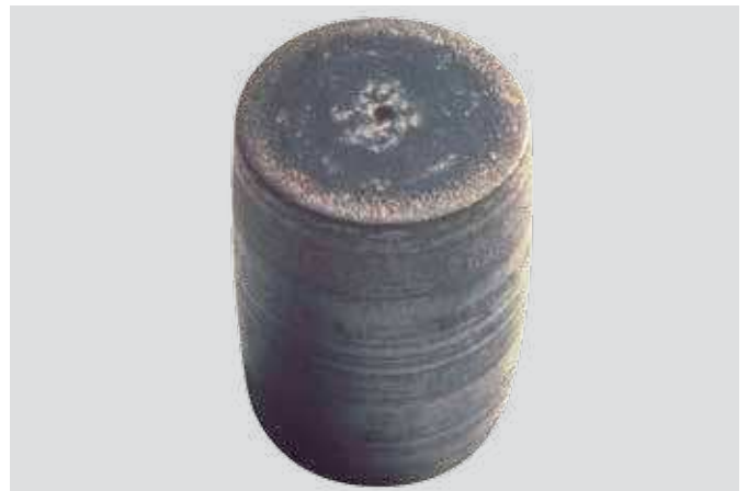
Rodillo de rodamiento de rodillos a rótula Rodillo corroído debido a penetración severa de agua en el rodamiento
