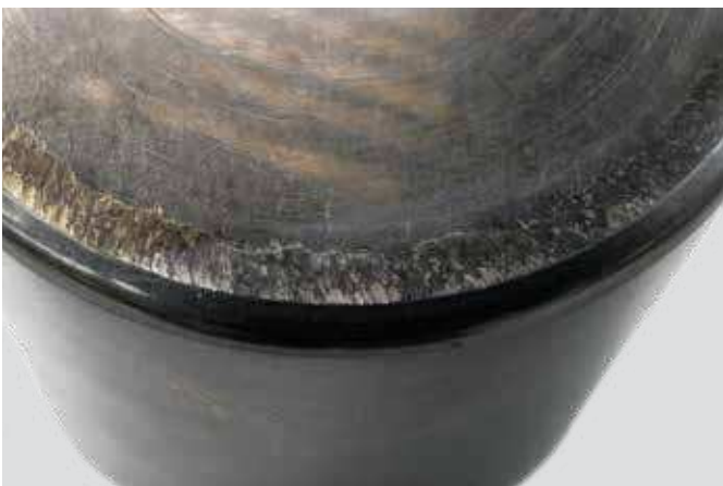
Rodillo de rodamiento de rodillos cónicos Contaminación y lubricación inadecuada que conduce al desgaste por adherencias; marcas en el extremo grande del rodillo
