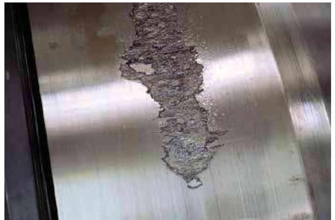
Aro interior de rodamiento de rodillos a rótula Fatiga del material
