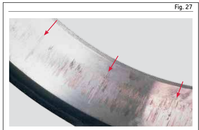
Vibrocorrosión ("estrías") sobre el camino de rodadura del aro exterior de un rodamiento de rodillos cilíndricos
