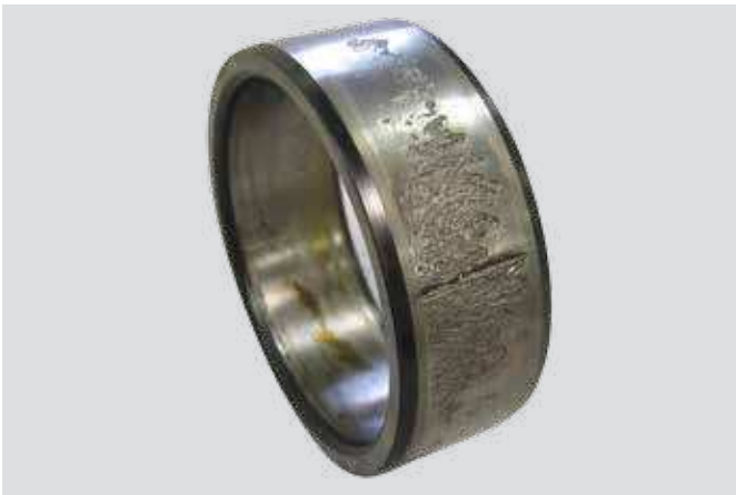
• Utilice las herramientas y métodos de montaje adecuados Aro interior de rodamiento de rodillos a rótula Descascarillado muy intenso; fractura por fatiga como daño posterior
