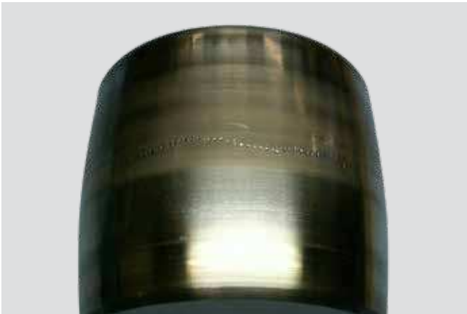
Rodillo de rodamiento de rodillos a rótula El exceso de corriente origina una gran cantidad de cráteres en una formación tipo collar de cuentas
