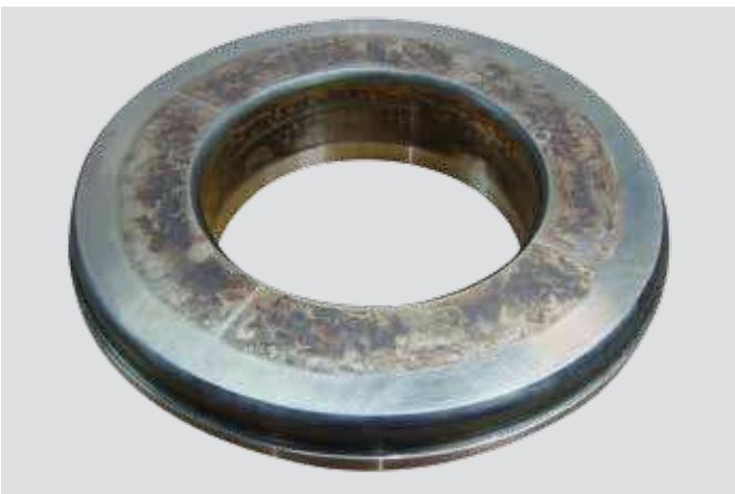
Arandela del eje de rodamiento axial de rodillos a rótula Asiento inadecuado
