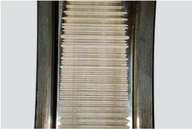
Aro exterior de rodamiento de rodillos cilíndricos Etapa avanzada de ondulación
