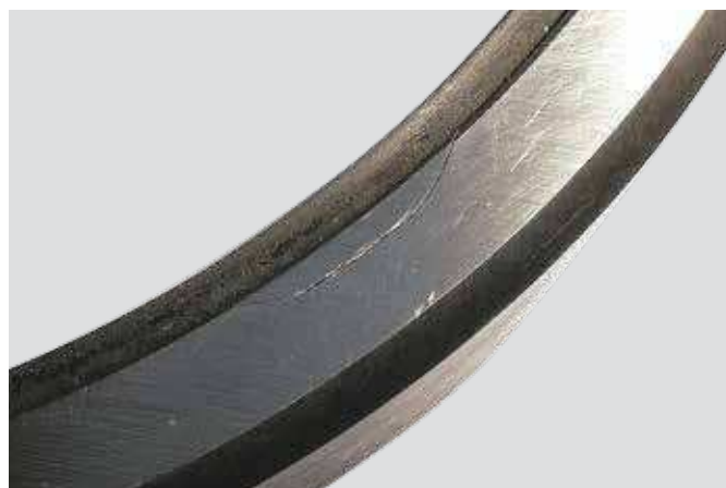
Cara lateral del aro exterior de rodamiento rígido de bolas Fractura en la ranura de fijación del sello debido a un impacto en el montaje
