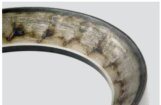
Aro exterior de rodamiento axial de rodillos a rótula Desgaste por adherencias inicial, luego generación de calor excesivo y por último, agarrotamiento
