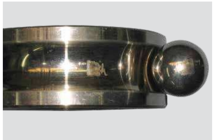
Aro interior y bola de un rodamiento rígido de bolas El exceso de corriente origina una cantidad de cráteres en una formación en zigzag sobre la bola y el camino de rodadura
