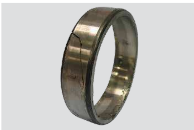
Aro exterior de rodamiento de bolas a rótula Fractura producida por desalineación excesiva y bolas que se desplazan sobre el borde del camino de rodadura
