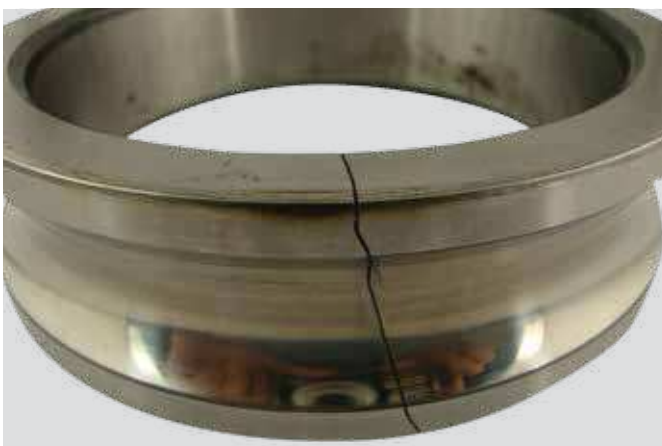
Aro interior de rodamiento rígido de bolas Aro fracturado debido a excesiva fricción contra una parte estacionaria del conjunto de rodamientos
