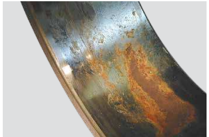
Aro interior de rodamiento de rodillos cilíndricos Ajuste de eje inadecuado, apoyo irregular
