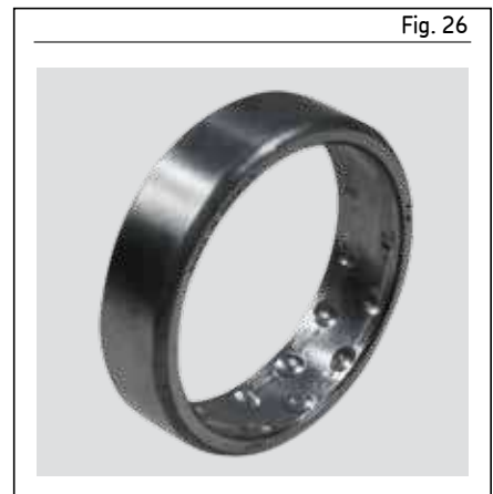
Vibrocorrosión severa en el camino de rodadura del aro exterior de un rodamiento de bolas a rótula
