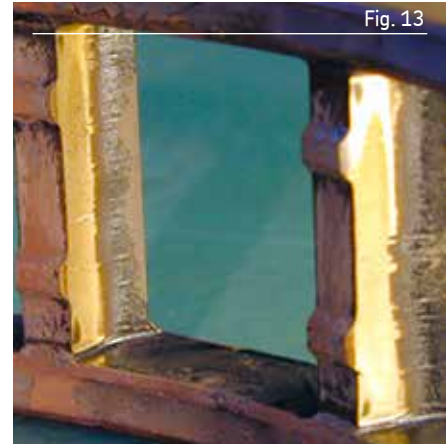
Desgaste abrasivo en las barras de la jaula de un rodamiento de rodillos cilíndricos
