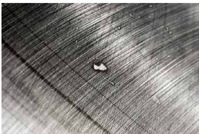
Aro exterior de rodamiento de rodillos a rótula Desplazamiento excesivo de partículas duras que ingresaron al rodamiento durante el montaje; falta de limpieza
