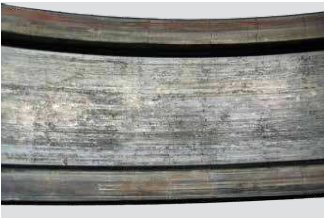
Aro exterior de rodamiento de rodillos cilíndricos Grietas térmicas en ambos contactos resalte-jaula debido a la lubricación inadecuada
