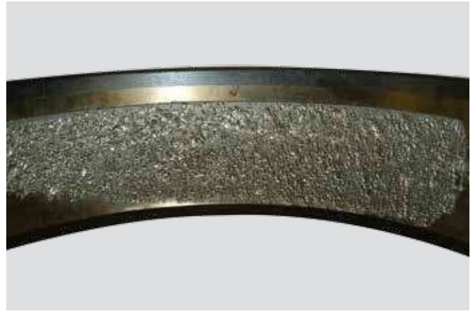
Aro exterior de rodamiento de rodillos cilíndricos Película de lubricante inadecuada, alguna desalineación, deformación superficial avanzada
