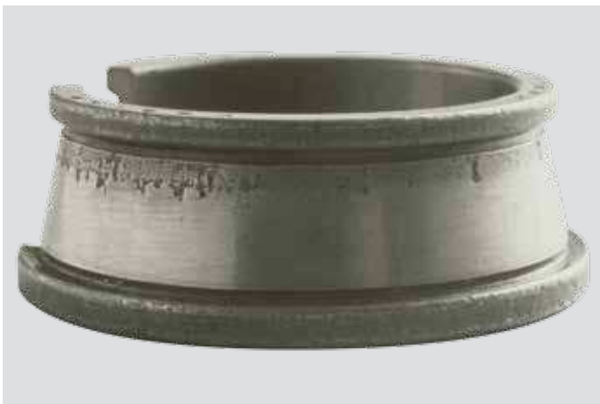
Aro interior de rodamiento de rodillos cónicos Descascarillado en solo un lado del camino de rodadura, resultante de desalineación y la consecuente carga sobre los bordes, que lleva a mayor tensión y falla
