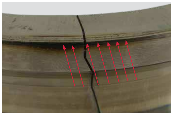
Aro interior de rodamiento rígido de bolas Vista ampliada del aro fracturado, con muchas grietas por calor a lo largo del resalte del aro interior
