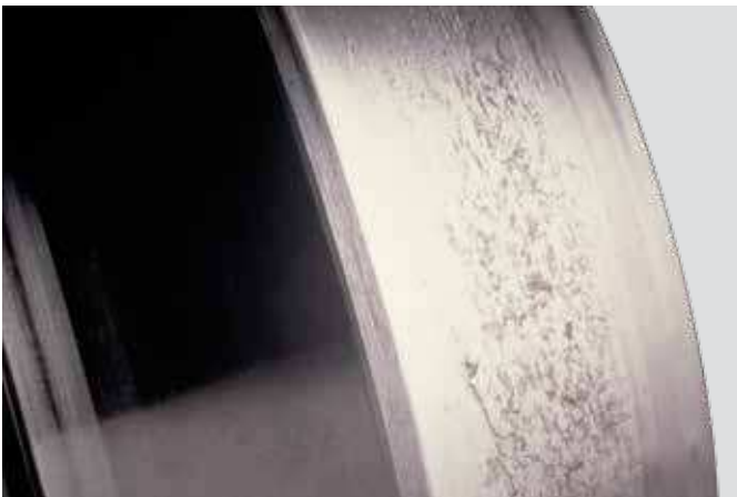
Aro interior de rodamiento de rodillos a rótula Carga demasiado baja combinada con lubricación inadecuada
