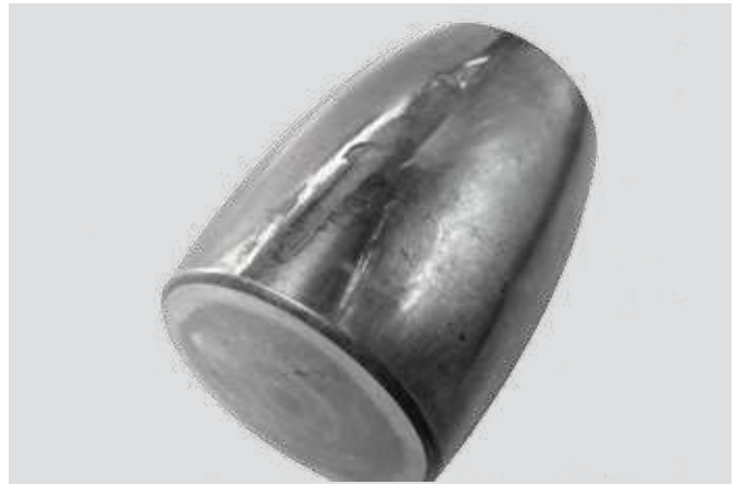
Rodillo de rodamiento axial de rodillos a rótula Fuerte impacto, deformación plástica
