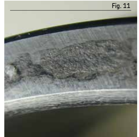
Aro exterior: Corrosión por contacto en la cara lateral
