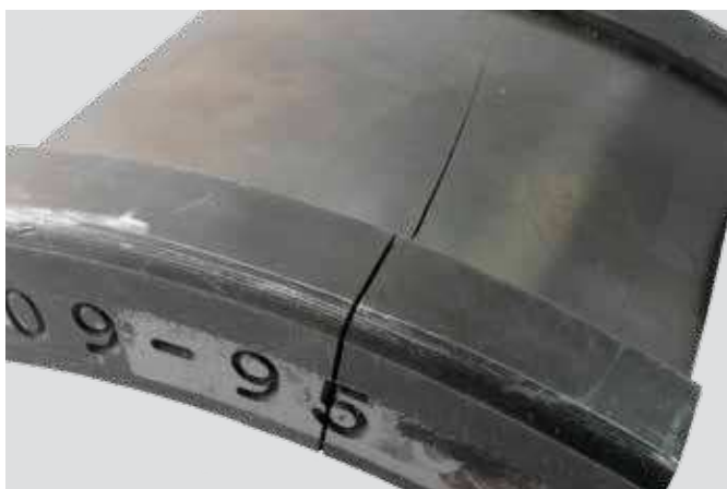
Aro interior de rodamiento de rodillos cónicos El rodamiento se instaló sobre un eje sobredimensionado
