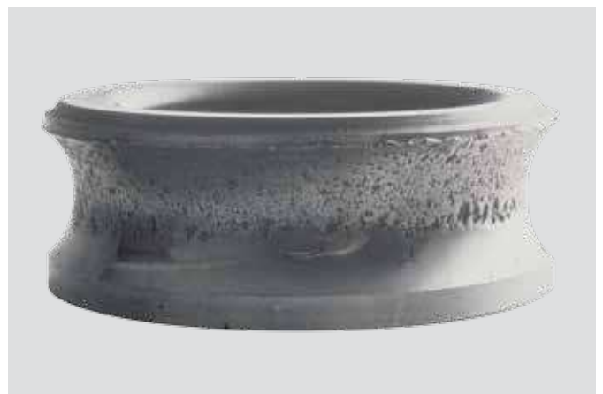
Aro interior de rodamiento rígido de bolas Carga axial excesiva, que da como resultado una película de lubricante demasiado fina y deformación superficial
