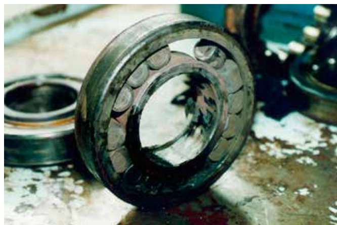
Rodamiento de rodillos cilíndricos; aro interior, aro exterior y rodillos Rodamiento agarrotado; fractura forzada de la jaula debido a problema de lubricación
