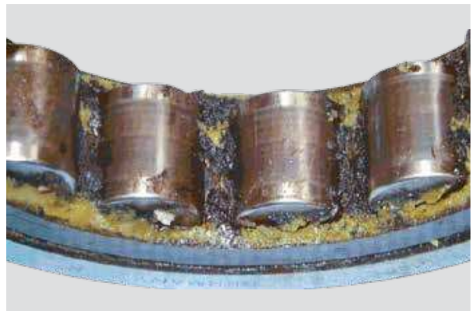
Aro exterior de rodamiento de rodillos cilíndricos con jaula, rodillos y grasa La fuga de corriente resultó en grasa quemada (negro) en las barras de la jaula
