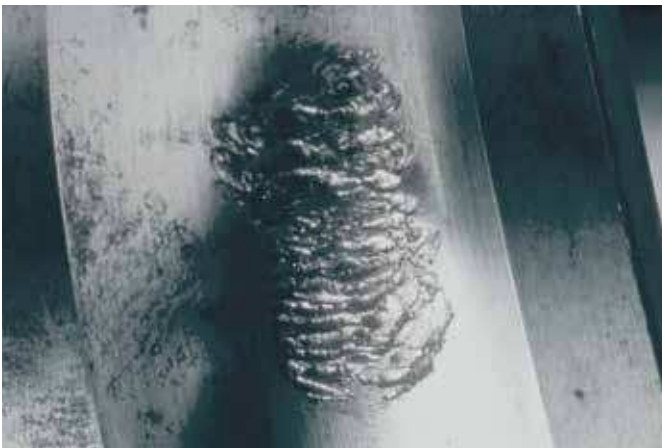
Aro interior de rodamiento rígido de bolas Fatiga del material
