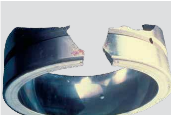
Aro exterior de rodamiento de rodillos a rótula Fractura por fatiga resultante del asiento de soporte inadecuado (viruta atrapada en la parte inferior del soporte)
