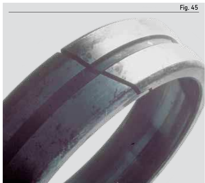
Fractura por fatiga de un aro exterior de un rodamiento de rodillos a rótula
