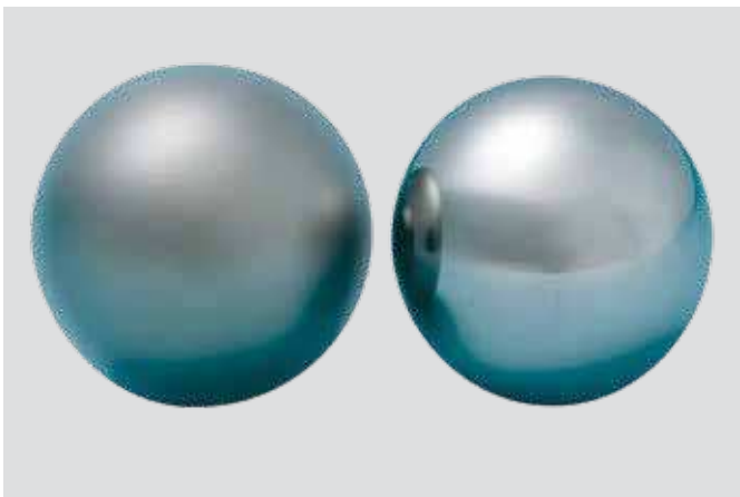
Bolas de rodamiento rígido de bolas Izquierda: bola dañada; superficie opaca Derecha: bola nueva; superficie brillante
