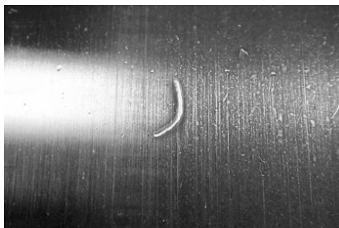
Aro exterior de rodamiento de rodillos a rótula El desplazamiento excesivo de las virutas/rebabas originarán descascarillado
