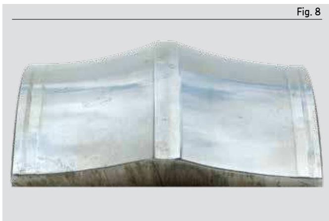
Aro interior: Fuerte desgaste abrasivo en los caminos de rodadura y ranura circunferencial en ambos bordes de los caminos de rodadura
