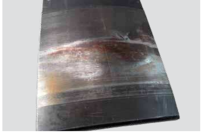
Aro exterior de rodamiento de rodillos cónicos (fosfatado) Apoyo del aro irregular
