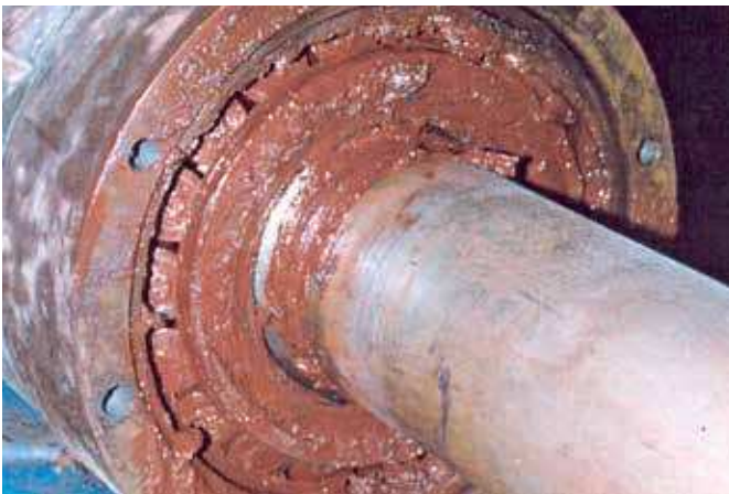
Rodamiento de rodillos cónicos en una unidad de bomba Falla del sello, corrosión del rodamiento y grasa rojiza descolorida
