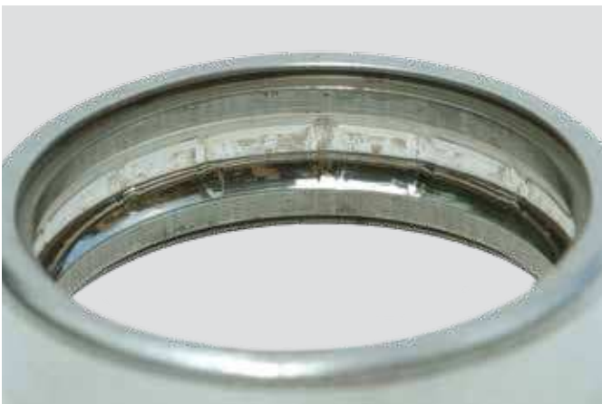
Aro exterior de rodamiento rígido de bolas Deformación plástica en el paso de la bola, por aplicación de fuerza de montaje sobre el aro incorrecto
