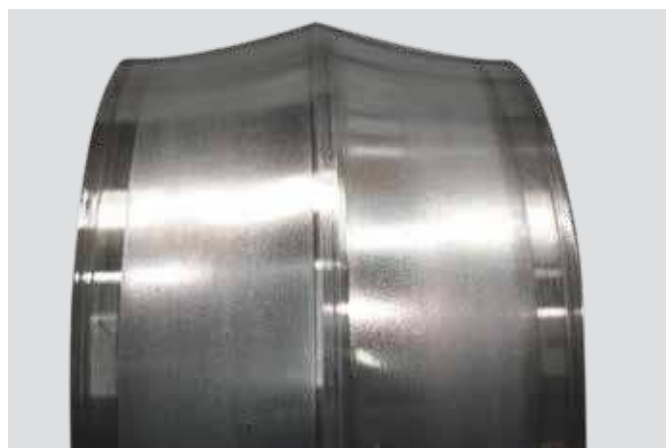
Aro interior de rodamiento de rodillos a rótula Múltiples pequeñas muescas resultantes del desplazamiento excesivo de partículas duras; disposición de sellado inadecuada
