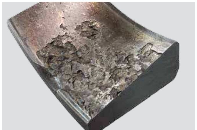
Aro exterior de rodamiento de rodillos cónicos Película de lubricante inadecuada que conduce a deformación superficial y descascarillado
