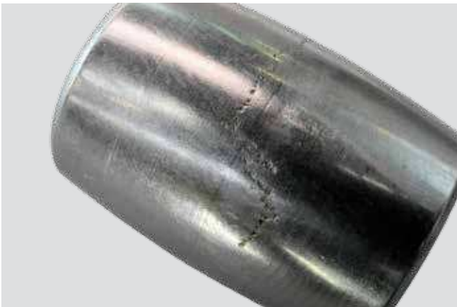
Rodillo de rodamiento de rodillos a rótula El exceso de corriente origina una gran cantidad de cráteres en una formación en zigzag
