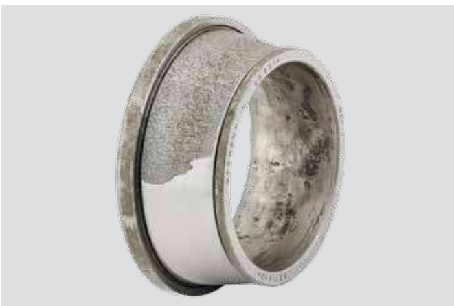
Aro interior de rodamiento de rodillos cónicos Película de lubricante inadecuada, deformación superficial sobre un área grande
