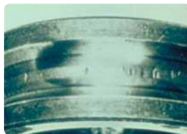
Этап 3: Перекатывание загрязнений, развитие выкрашивания поверхности.
