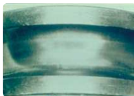
Этап 1: На поверхности появляется мелкая шероховатость или волнистость.
