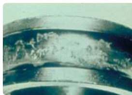
Этап 4: При длительной работе происходит выкрашивание всей дорожки качения. На данном этапе уже сложно определить первопричину повреждения.
