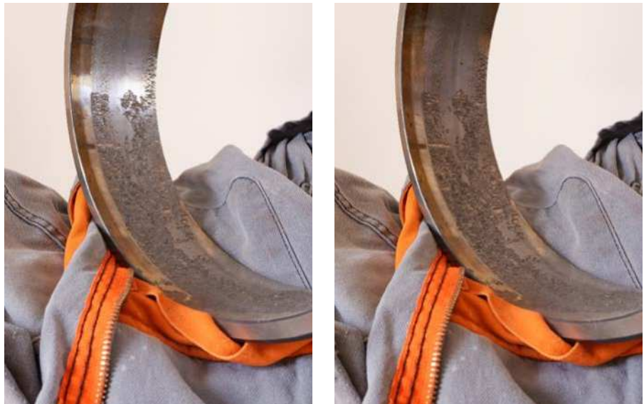
Fig. 18: imagen de la izquierda, la luz desde una ventana se reflejaba sobre el camino de rodadura del rodamiento. Imagen de la derecha, mi esposa se colocó entre el rodamiento y la ventana
