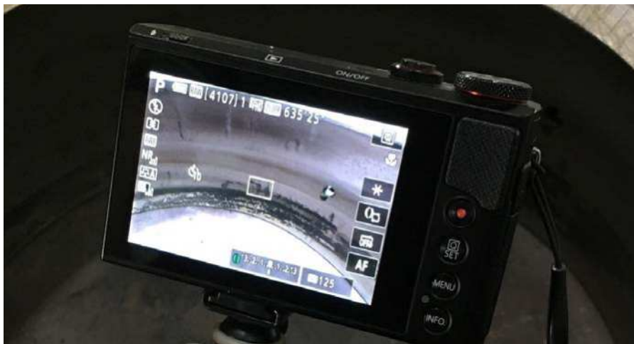
Fig. 7: cámara en ISO 125, el más bajo para esa cámara, en un trípode y con disparador automático
