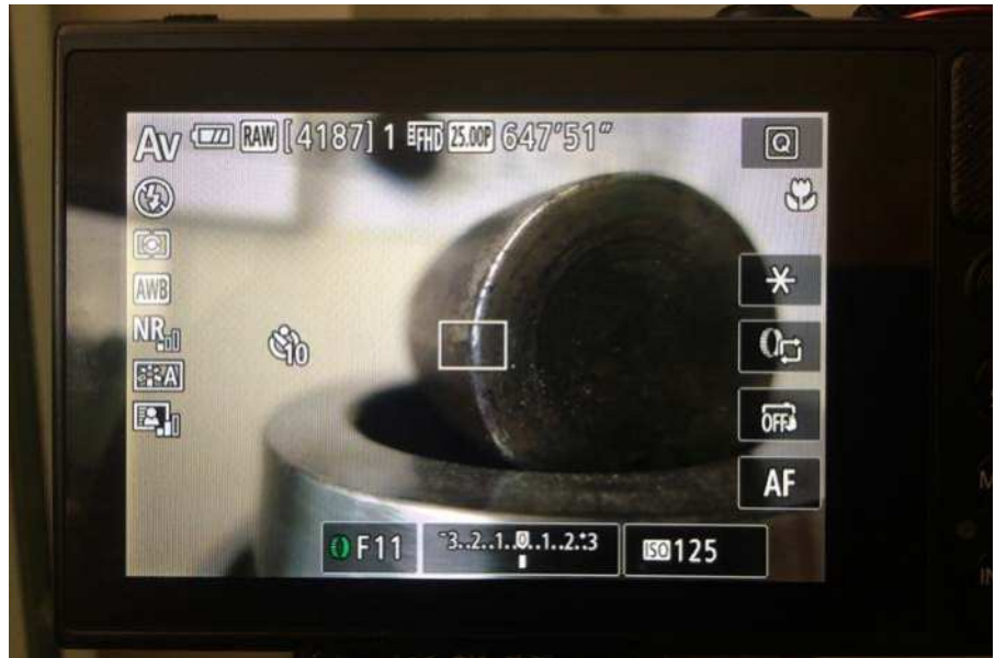
Fig. 25: modo macro (flor pequeña en la parte superior derecha), ISO 125, el más bajo para evitar el ruido en esta cámara, apertura cerca de su máximo para tener profundidad de campo máxima, disparador automático y trípode. Tenga en cuenta que la profundidad de campo es más pequeña en la pantalla de la cámara que en la fotografía final (fig. 26), porque la apertura está bien abierta durante el ajuste y solo se cerrará al presionar el botón del obturador
