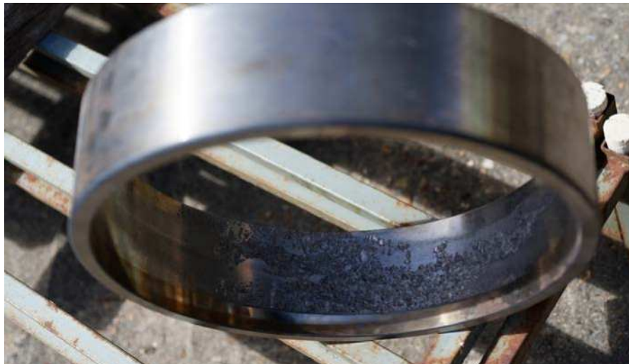
Fig. 39: aro del rodamiento en el sol, rotura en la sombra
