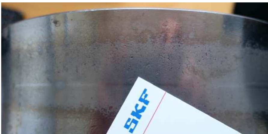
Fig. 23: una tarjeta de visita puede aportar un fuerte contraste y ayudar a la cámara a enfocar
