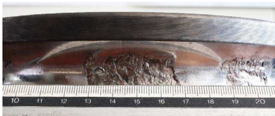
Fig. 2: gran rotura en una ranura profunda del aro interior de un rodamiento. Aplicación: motor industrial eléctrico
