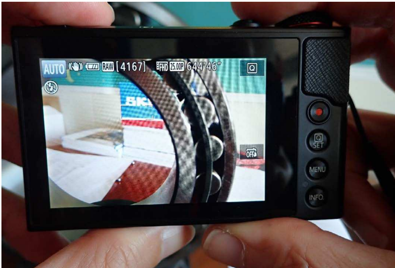
Fig. 21: modo totalmente automático, el icono de enfoque (esquinas del rectángulo blanco) pasa directamente al fondo en cuanto el rodamiento se aleja del centro de la pantalla
