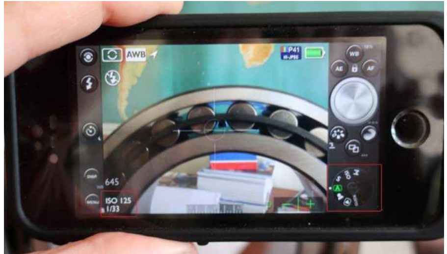
Fig. 24: teléfono inteligente con aplicación del mercado de accesorios que ofrece información y control sobre el ISO y la velocidad de obturación
