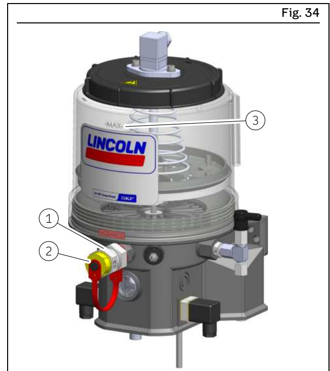
Filling via the optional fill connection
