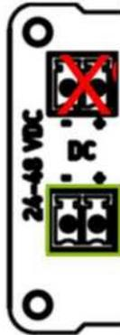
*Figura 4 Ubicación de los terminales de alimentación del sistema IMx-16Plus*
