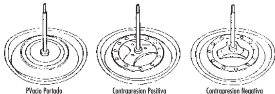
FIGURA 8: DIAFRAGMAS DE RECIRCULACIÓN DE LOS GASES DE ESCAPE FABRICADOS POR GM
