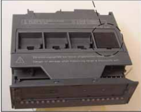
Atlama Kablosu Lokasyonu
