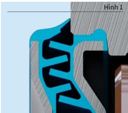
Phốt ổ bi được cấp bằng sáng chế.
