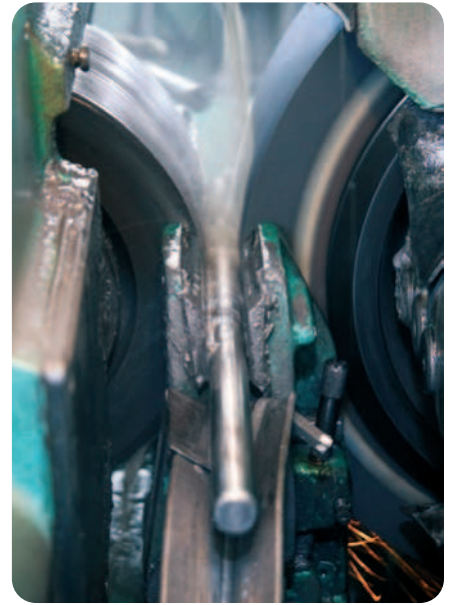
Bolzen werden präzisionsgeschliffen, um eine hohe Verschleißfestigkeit zu erreichen und die Lebensdauer der Kette zu maximieren.
