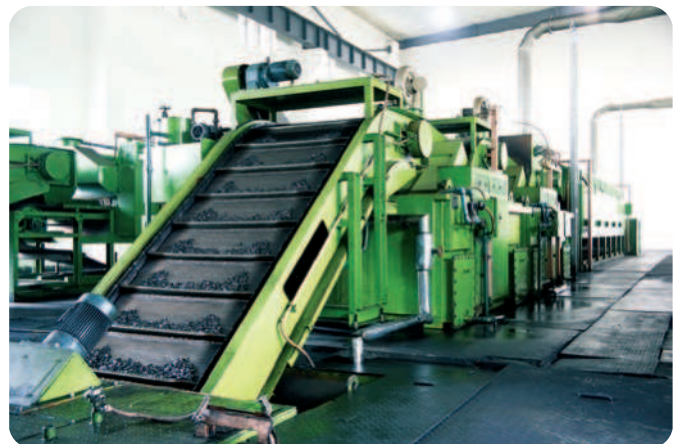
Durchlaufofenlinie zur Wärmebehandlung von Rollen und Buchsen (z.B. Karbonitrieren)
