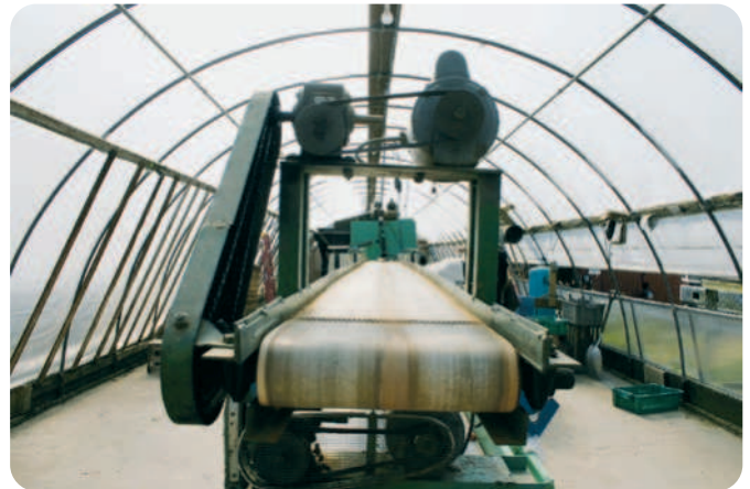
Einsatz von SKF wartungsfreien Hochleistungsrollenketten SLR in der Lebensmittelverarbeitung
