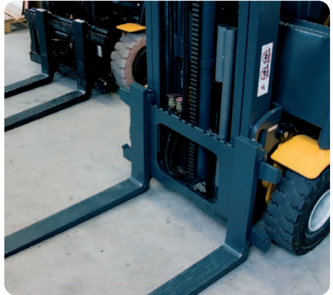
Einsatz von SKF Flyerketten zum Heben in einem Gabelstaplermast
