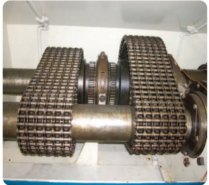
Mehrsträngige SKF Ölfeldketten in einer Schlammpumpe
