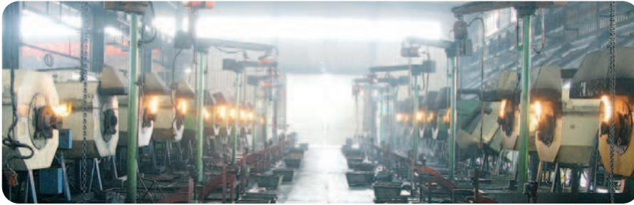
Bei der Wärmebehandlung erzeugen Drehöfen eine gleichmäßige Wärme, die für einheitliche und gleichmäßige Ergebnisse sorgt.
