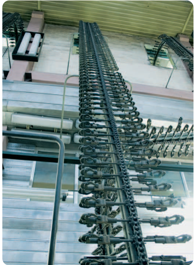
Einsatz von SKF Hohlbolzenketten in Förderbändern für Zeitungen
