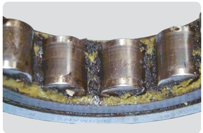
Bague extérieure de roulement à rouleaux cylindriques avec cage, rouleaux et graisse Graisse carbonisée (noire) sur les barrettes de la cage en raison d'une fuite de courant
