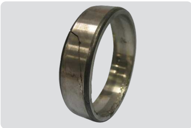
Bague extérieure de roulement à rotule sur billes Rupture résultant d'un défaut d'alignement excessif et du roulement des billes sur le bord de la piste
