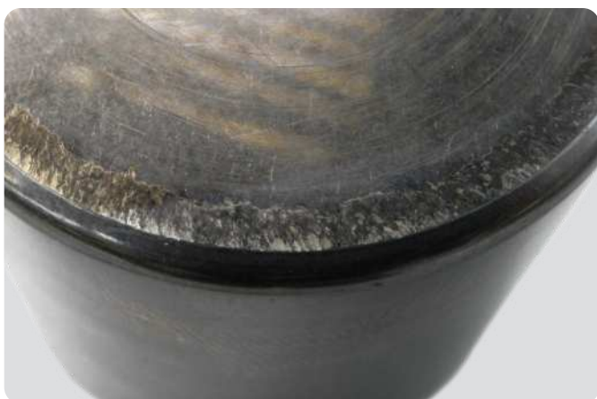
Roulement à rouleaux coniques - rouleau Contamination et lubrification inappropriée se traduisant par des marques d'usure par adhésion sur la plus grande face du rouleau
