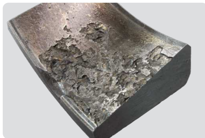
Bague extérieure de roulement à rouleaux coniques Film lubrifiant inapproprié conduisant à une altération de la surface et un écaillage sévère
