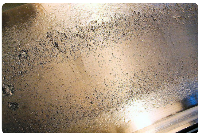
Bague intérieure de roulement à rotule sur rouleaux Lubrification inappropriée, altération de la surface avec début d'écaillage
