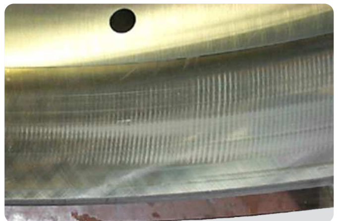
Bague extérieure de roulement à rotule sur rouleaux Érosion due à une fuite de courant
