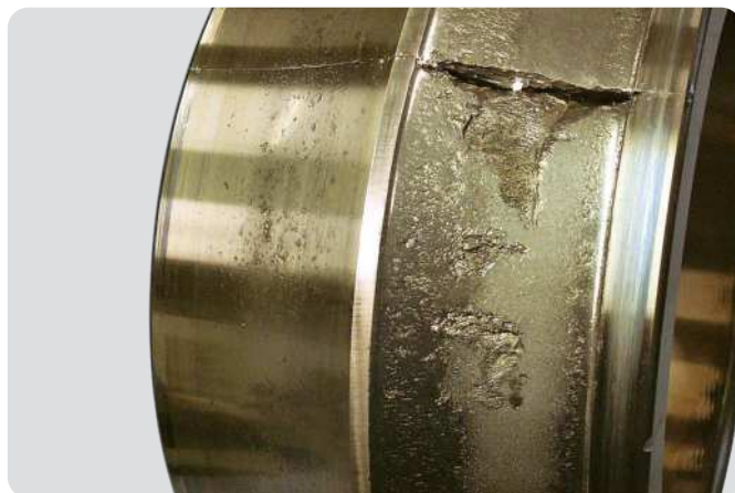
Bague intérieure de roulement à rotule sur rouleaux Écaillage très sévère - rupture par fatigue consécutive
