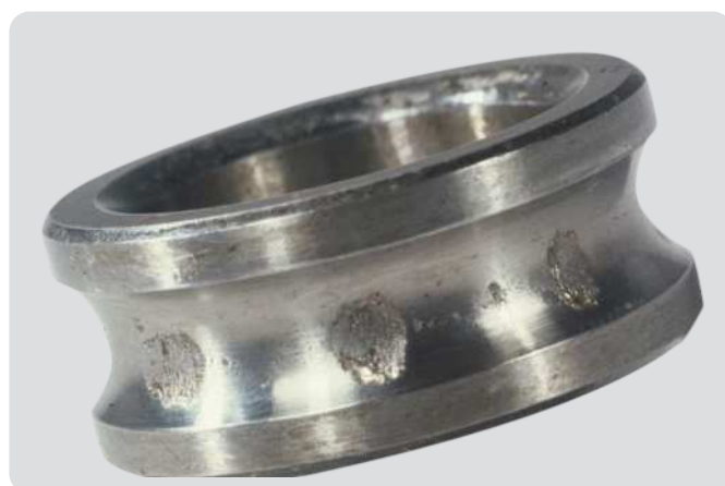
Bague intérieure de roulement rigide à billes Impact au cours du montage ayant entraîné un écaillage qui reproduit l'espacement des billes
