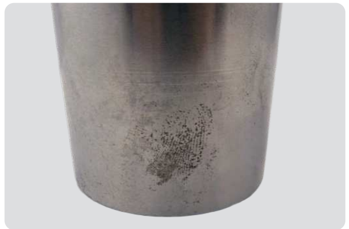
Roulement à rouleaux coniques - rouleau Surface de piste rouillée à cause de la transpiration des doigts
