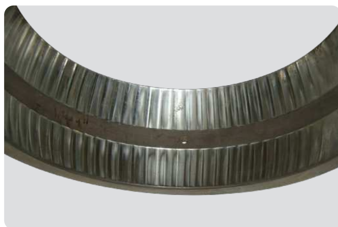
Bague extérieure de roulement à rotule sur rouleaux Expositions à des vibrations excessives à l'arrêt, séries de marques de faux effet Brinell de même espacement que les rouleaux
