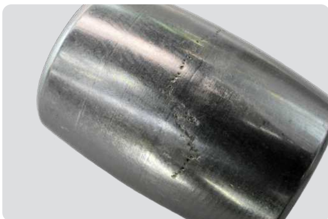
Roulement à rotule sur rouleaux - rouleau Érosion due à une surtension entraînant la formation de nombreux cratères disposés en zigzags
