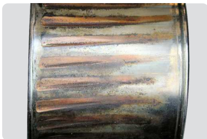
Bague intérieure de roulement à rouleaux toroïdaux CARB Expositions à des vibrations à l'arrêt avec petits mouvements oscillatoires, marques de faux effet Brinell de même espacement que les rouleaux
