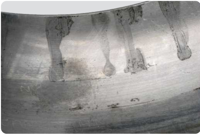
Bague extérieure de roulement à rotule sur rouleaux Quantité d'eau excessive dans le lubrifiant, séries de marques d'attaque à l'arrêt de même espacement que les rouleaux
