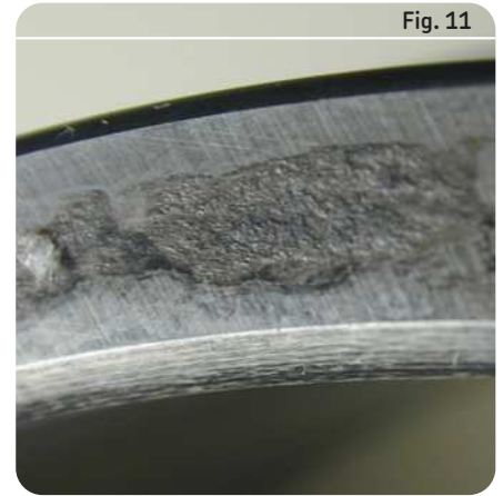
Bague extérieure : Corrosion de contact sur la face latérale
