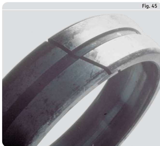
Rupture par fatigue d'une bague extérieure de roulement à rotule sur rouleaux
