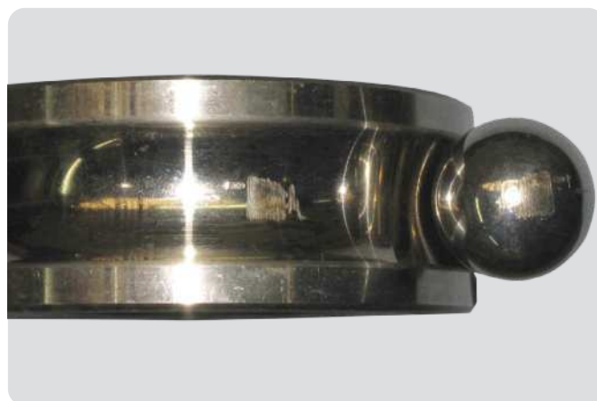
Bagues intérieure de roulement rigide à billes et bille Érosion due à une surtension entraînant la formation de nombreux cratères disposés en zigzags sur la bille et la piste
