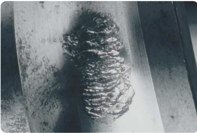
Bague intérieure de roulement rigide à billes Fatigue du matériau
