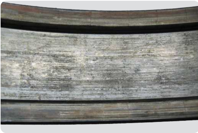
Bague extérieure de roulement à rouleaux cylindriques Fissures thermiques au niveau du contact épaulement-cage dues à une lubrification inappropriée
