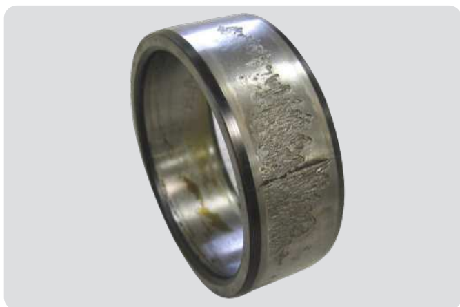
Bague intérieure de roulement à rouleaux cylindriques Écaillage très sévère - rupture par fatigue consécutive
