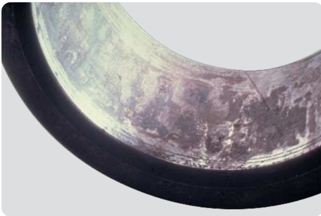
Bague intérieure de roulement à rouleaux cylindriques Ajustement sur l'arbre inapproprié (trop libre)
