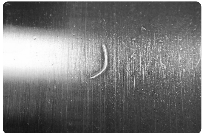
Bague extérieure de roulement à rotule sur rouleaux Le refoulement des copeaux entraînera un écaillage
