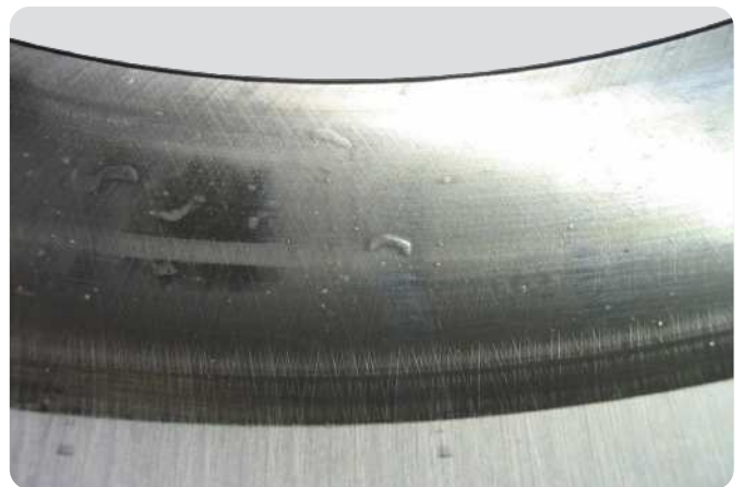
Bague extérieure de roulement à rotule sur rouleaux Refoulement de copeaux ayant pénétré à l'intérieur du roulement pendant le montage - manque de propreté
