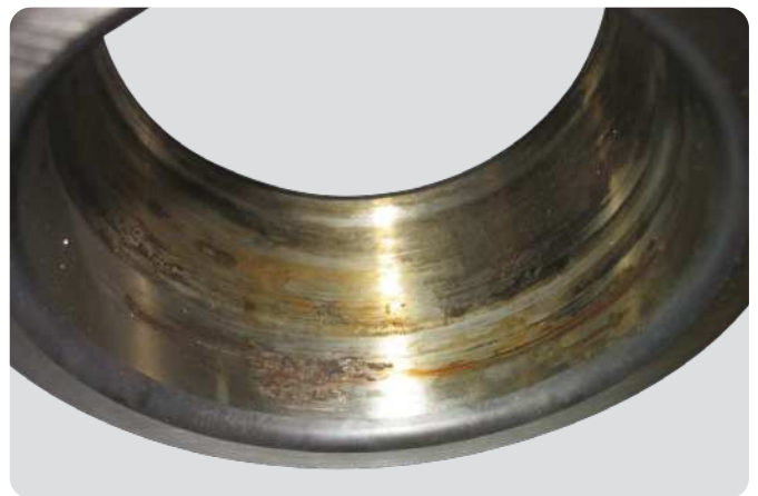
Bague intérieure de roulement à rouleaux coniques Ajustement sur l'arbre inapproprié
