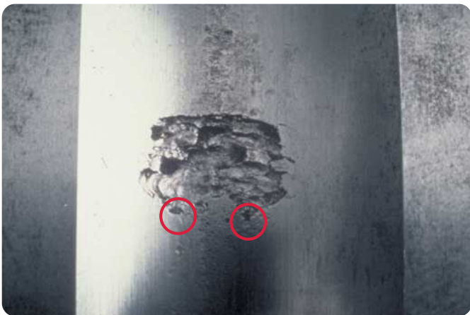
Bague intérieure de roulement rigide à billes Refoulement de particules et écaillage consécutif initié en aval des empreintes
