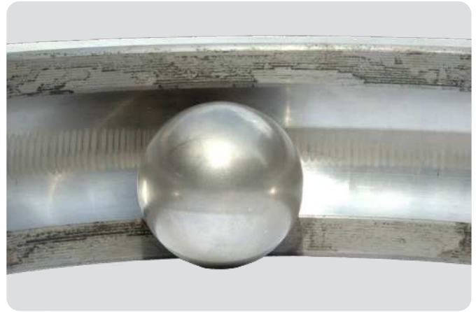
Bagues extérieure de roulement rigide à billes et bille Rainurage dans la bague extérieure et surface d'aspect mat de bille
