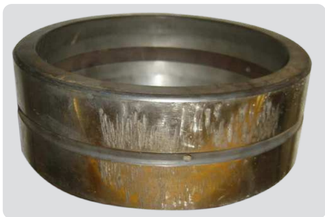
Bague extérieure de roulement à rotule sur rouleaux Zone de corrosion de contact d'aspect brun résultant des micro-mouvements dus à un écaillage avancé des pistes, et rayures causées par un démontage
