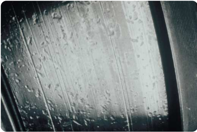
Bague intérieure de roulement à rouleaux coniques Refoulement de grosses particules dures ayant pénétré à l'intérieur du roulement en raison d'un dispositif d'étanchéité inapproprié
