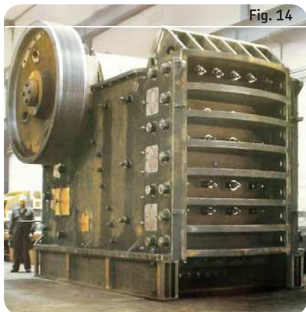
Concasseur à mâchoires typique de grandes dimensions
