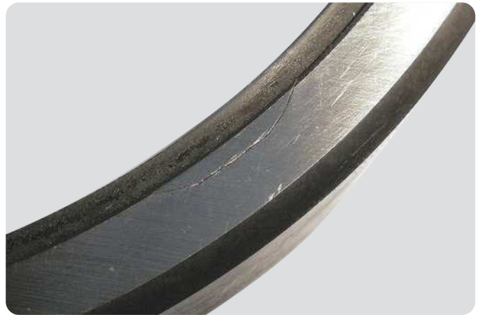
Face latérale de la bague extérieure d'un roulement rigide à billes Rupture au niveau de la rainure d'ancrage du joint due à un impact lors du montage du roulement
