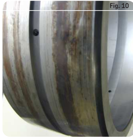
Bague extérieure : Corrosion de contact sur la surface extérieure
