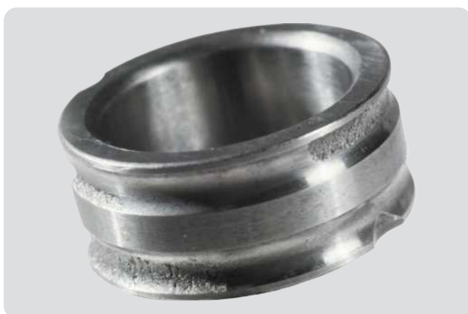
Bague intérieure de roulement à billes à contact oblique à deux rangées Défaut d'alignement excessif induisant des charges excessives avec deux zones de charge distantes disposées à 180°
