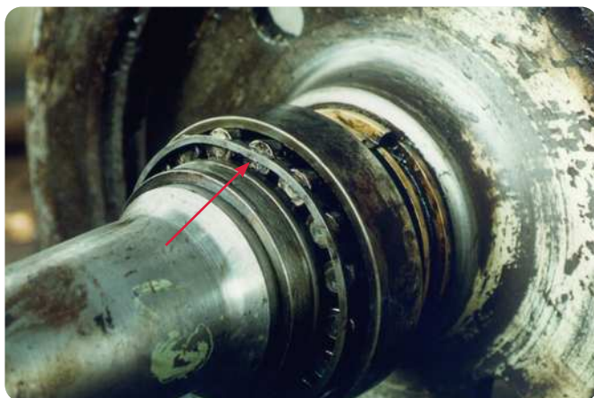
Roulement à rouleaux coniques monté sur une boîte d'essieu ferroviaire La cage a été frappée directement lors du montage, ce qui a causé une déformation permanente (aplanissement)
