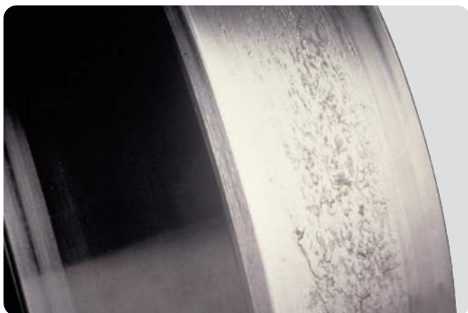
Bague intérieure de roulement à rotule sur rouleaux Charge trop faible associée à une lubrification inappropriée
