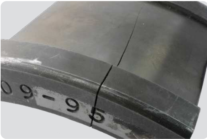
Bague intérieure de roulement à rouleaux coniques Le roulement a été monté sur un arbre surdimensionné
