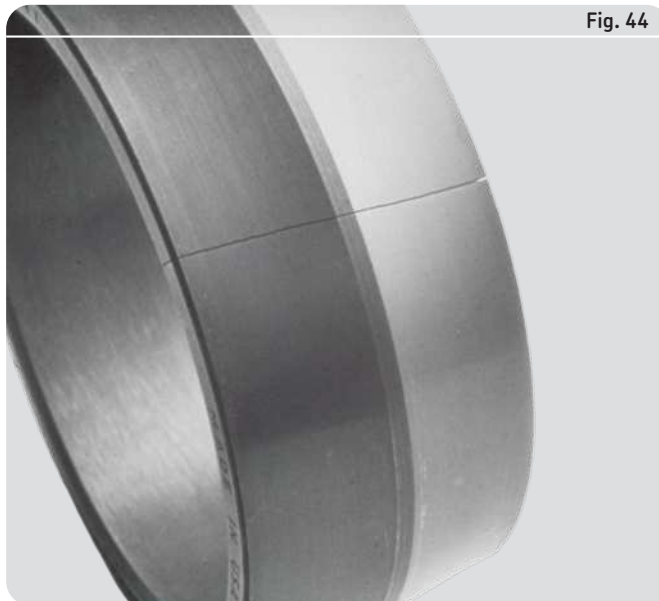
Rupture d'une bague intérieure de roulement à rotule sur rouleaux à alésage conique résultant d'un enfoncement excessif
