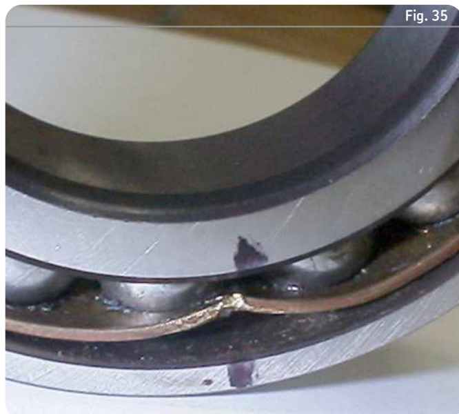
Déformation plastique sur la cage d'un roulement à billes à contact oblique causée par une mauvaise manutention
