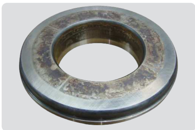
Rondelle-arbre de butées à rotule sur rouleaux Portée inappropriée
