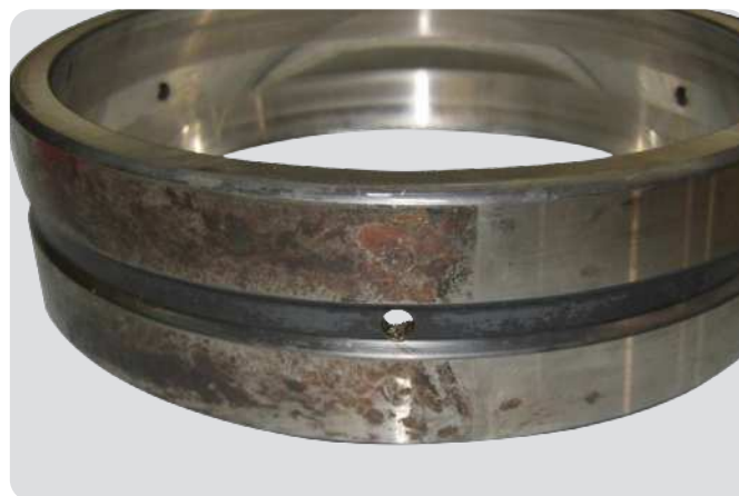
Bague extérieure de roulement à rotule sur rouleaux Support de bague inapproprié
