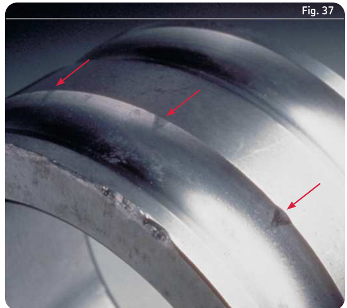
Empreintes de même espacement que les billes sur une piste de roulement à deux rangées de billes à contact oblique dues à une manutention incorrecte
