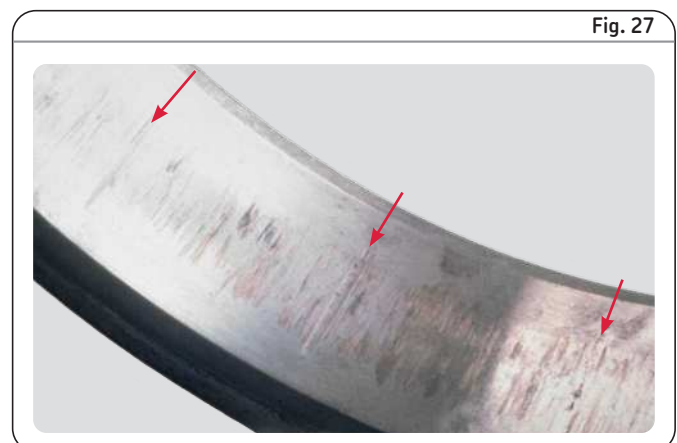
Faux effet Brinell (« cannelures ») sur la piste de la bague extérieure d'un roulement à rouleaux cylindriques
