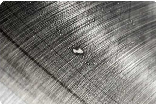
Bague extérieure de roulement à rotule sur rouleaux Refoulement de particules dures ayant pénétré à l'intérieur du roulement pendant le montage - manque de propreté
