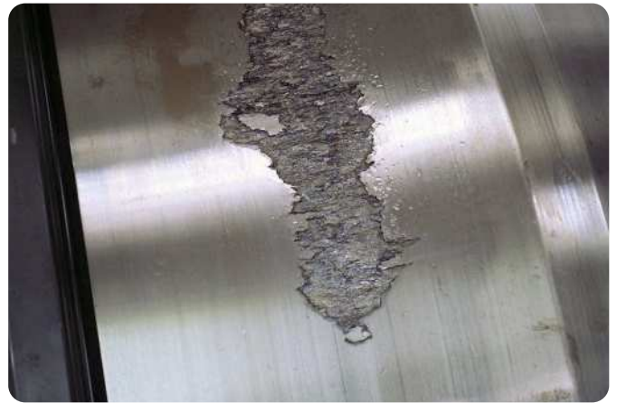
Bague intérieure de roulement à rotule sur rouleaux Fatigue du matériau
