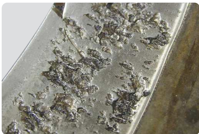
Bague extérieure de roulement à rotule sur rouleaux Au début, usure par abrasion due à la contamination, évoluant vers une altération de la surface et un écaillage sévère
