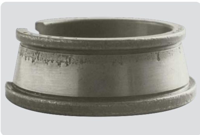
Bague intérieure de roulement à rouleaux coniques Écaillage d'un seul côté de la piste, résultant d'un défaut d'alignement et des charges de bord associées, et se traduisant par une hausse des contraintes et, au bout du compte, une défaillance
