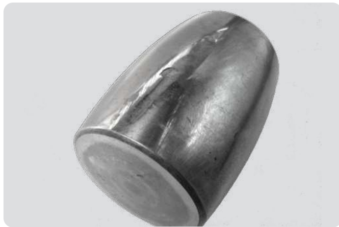
Butée à rotule sur rouleaux - rouleau Impact important, déformation plastique
