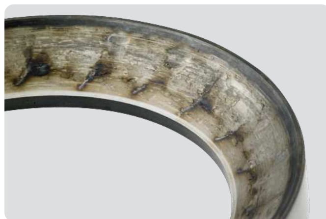
Bague extérieure de butée à rotule sur rouleaux Dans un premier temps : usure par adhésion, puis échauffement excessif, pour finir : coincement
