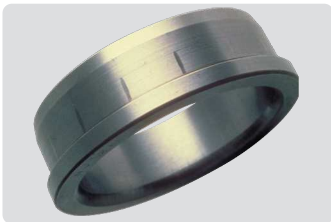
Bague intérieure de roulement à rouleaux cylindriques Lors du montage, les bagues intérieure et extérieure n'ont pas été correctement alignées. Marques axiales de même espacement que les rouleaux
