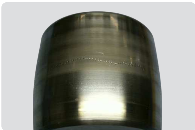
Roulement à rotule sur rouleaux - rouleau Érosion due à une surtension entraînant la formation de nombreux cratères disposés en cordon
