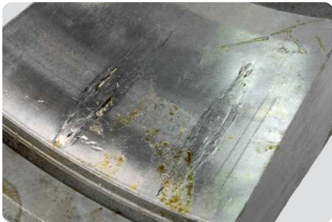
Bague extérieure de roulement à rouleaux coniques à deux rangées Surcharge et défaut d'alignement à l'arrêt entraînant une déformation ainsi qu'un écaillage consécutif, de même espacement que les rouleaux
