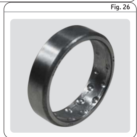
Faux effet Brinell sévère sur la piste de la bague extérieure d'un roulement à rotule sur billes
