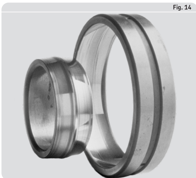
Usure par polissage (surfaces des pistes polies miroir) sur les bagues intérieure et extérieure d'un roulement à rotule sur rouleaux
