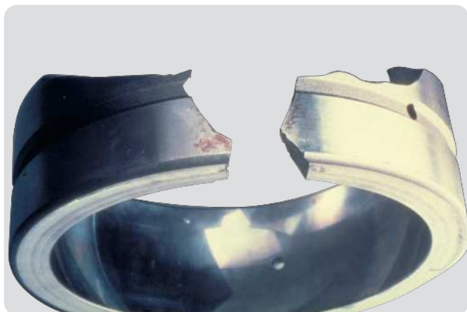
Bague extérieure de roulement à rotule sur rouleaux Rupture par fatigue résultant d'une portée défectueuse dans le palier (copeau emprisonné dans le fond du palier)
