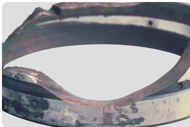
Bague extérieure de roulement à rotule sur rouleaux Défaut de la portée dans le palier conduisant à une corrosion de contact et, au final, à une rupture par fatigue
