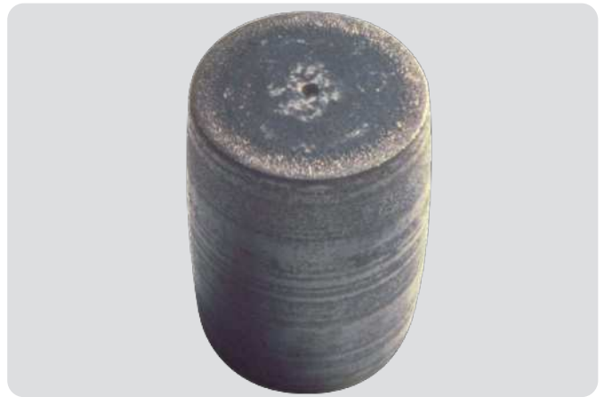
Roulement à rotule sur rouleaux - rouleau Rouleau corrodé en raison d'une pénétration d'eau importante à l'intérieur du roulement
