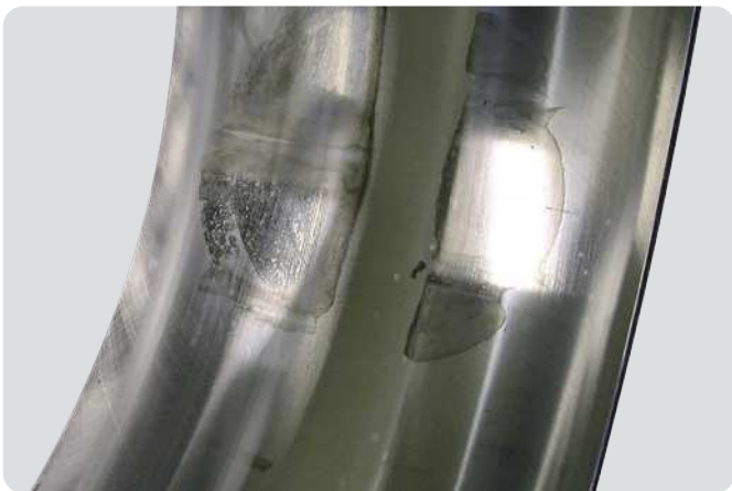
Bague extérieure de roulement à rotule sur rouleaux Défaillance du dispositif d'étanchéité, corrosion à l'arrêt
