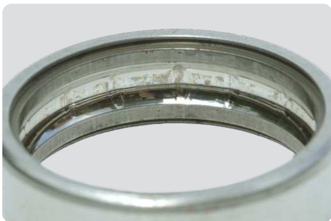
Bague extérieure de roulement rigide à billes Déformation plastique selon un espacement identique à celui des billes causée par l'application de la force de montage sur la mauvaise bague
