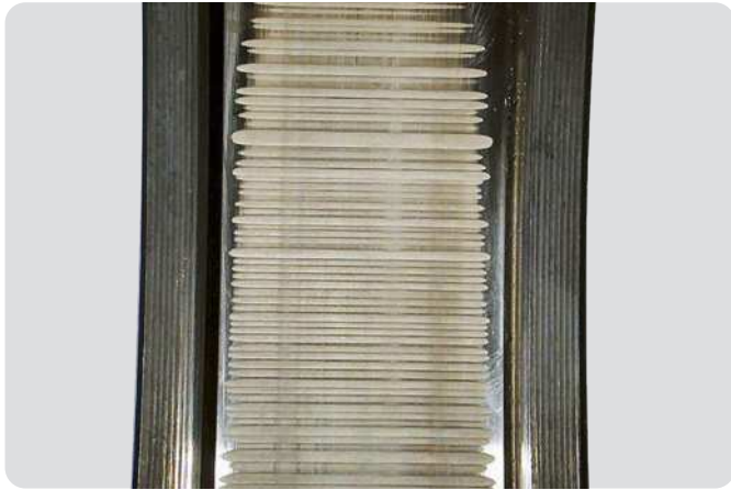
Bague extérieure de roulement à rouleaux cylindriques Rainurage avancé
