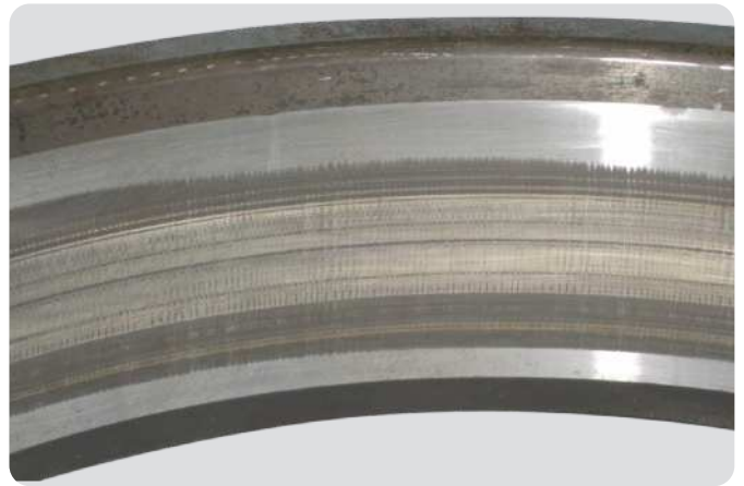
Bague extérieure de roulement à rouleaux cylindriques Début de rainurage
