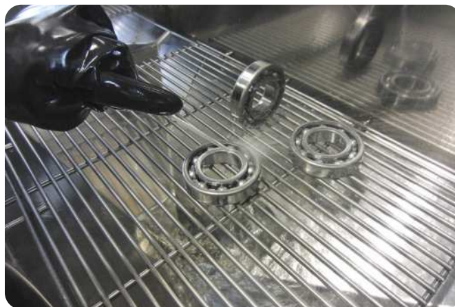
Évaluation de la propreté (analyse de la contamination) - rinçage
