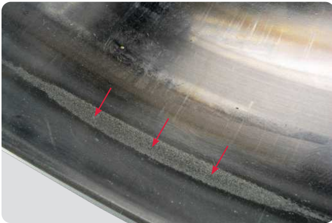
Bague extérieure de roulement à rotule sur rouleaux Détérioration au stade initial : zone d'aspect mat et grisâtre avec des cratères de faible profondeur
