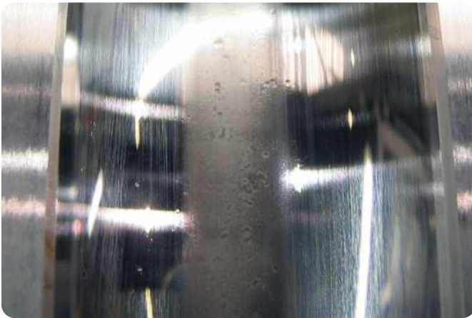
Bague intérieure de roulement rigide à billes Empreintes résultant du refoulement de particules dures - dispositif d'étanchéité inapproprié
