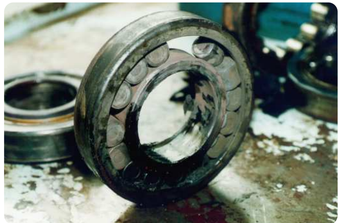
Roulement à rouleaux cylindriques - bague intérieure, bague extérieure et rouleaux Roulement grippé - rupture forcée de la cage due à un problème de lubrification
