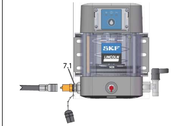
Regelmäßiges Befüllen mit Transferpumpe
