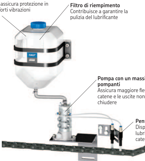
Configurazione esemplificativa di un sistema di lubrificazione catene OCL-M con pompa a 3 stadi, serbatoio da 5 litri e due pennelli
