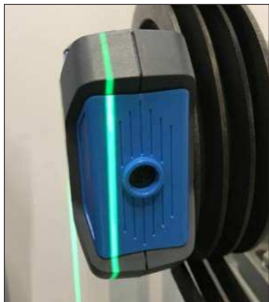
Рис. 7 – Отображение параллельного перекоса (смещение)
