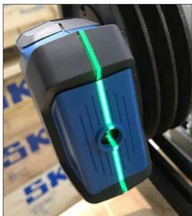
Рис. 6 – Отображение горизонтального углового перекоса
