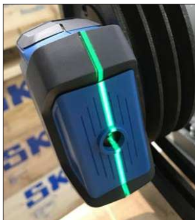
Fig. 6 – Esempio disallineamento angolare orizzontale
