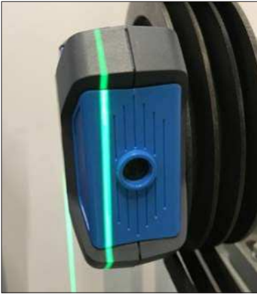
Bild 7: Darstellung einer Parallelschiefstellung (Versatz)
