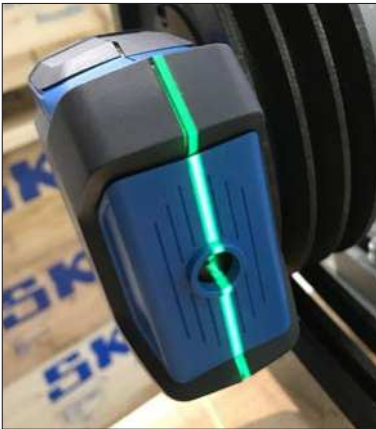
Bild 6: Darstellung eines horizontalen Winkelversatzes
