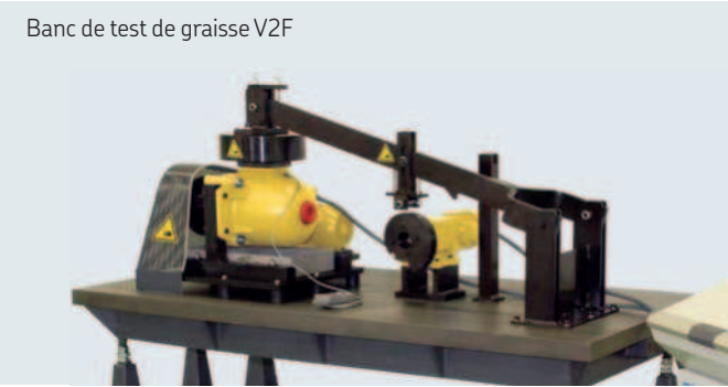
Banc de test de stabilité au roulement
