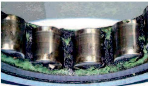
Verschmutzter Schmierstoff durch Funkerosion
