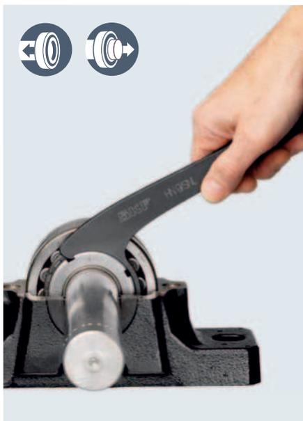
Leichter und schneller Ein- und Ausbau von Lagern in SNL-Gehäusen
