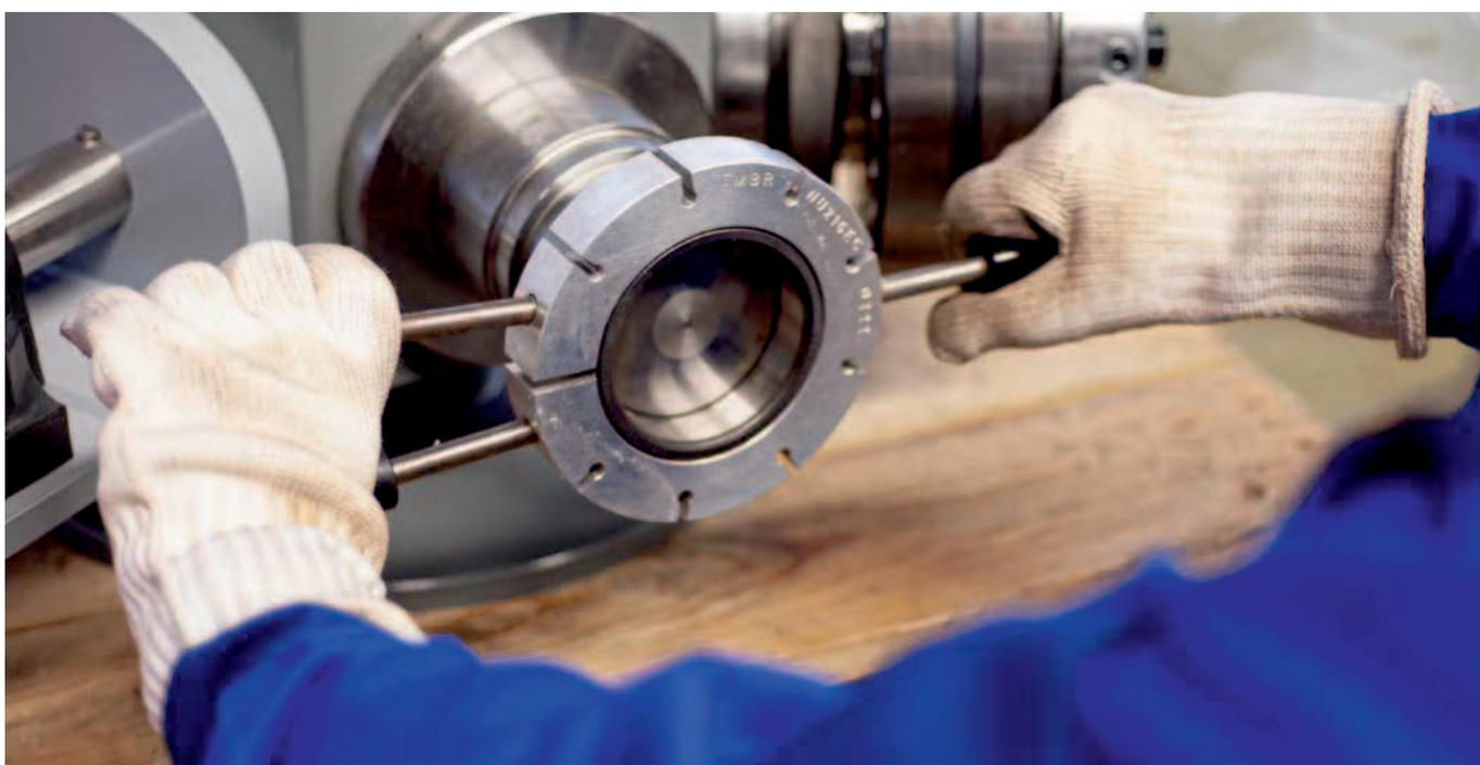
SKF Aluminium-Thermoringe der Baureihe TMBR werden so gefertigt, dass sie genau auf einen bestimmten Lagerring passen. Die Listen mit den Bestellangaben erleichtern es, den richtigen TMBR für eine bestimmte Lagerbezeichnung zu finden.
