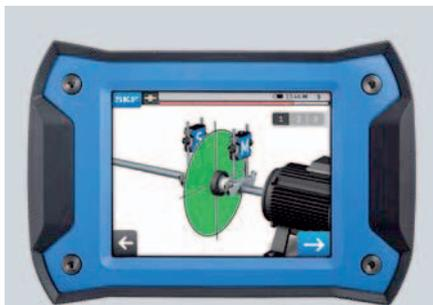
Bei der „freien Messung“ kann die Ausrichtungsmessung bei einem beliebigen Winkel gestartet und bei einer Winkelbewegung von gerade mal 90° beendet werden.
