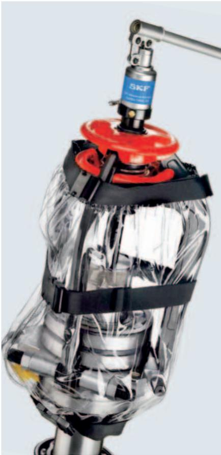
Für zusätzliche Bediener-sicherheit beim Ausbau
