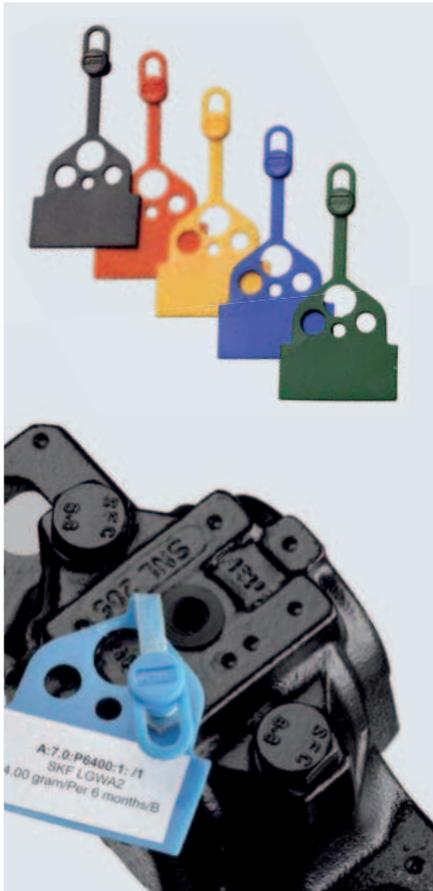
Korrekte Kennzeichnung der Schmierstellen
