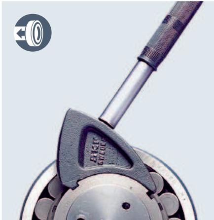
Hohe Schlagkräfte ohne Beschädigung der Wellenmutter
