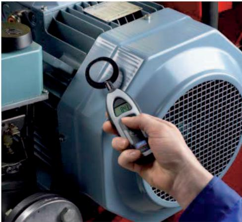
Elektromotoren mit variablem Frequenzantrieb sind wesentlich anfälliger für Funkerosion in Wälzlagern. Als Teil eines zustandsabhängigen Instandhaltungsprogramms lassen sich mithilfe eines EDD Pens stromdurchgangsgefährdete Wälzlager erkennen und so ungeplante Maschinenstillstandszeiten vermeiden.
